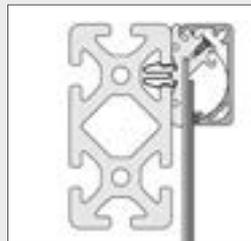
Das Vorlagenhalter-Trägerprofil wird mittels Klipp 8 St auf Grundkonstruktionen aus Profilen der Baureihe 8 aufgerastet.
