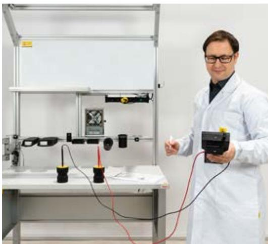
Ihre ESD-sicheren Lösungen werden gemäß IEC 61340 mit kalibrierten Messgeräten überprüft und mit einem Messprotokoll ausgeliefert.
