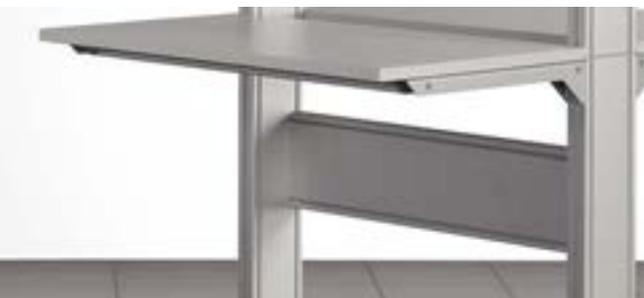
Tischplatten werden rechts und links mit dem Tischplattenträgersatz 8 an den Tischsäulen angebracht. Über Lochreihen lassen sich – beim Tischplattenträger 8 auch beidseitig – stützende Unterzüge anschließen.
