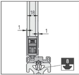
Das Schiebetür-Führungsprofil 8 40x10 wird mit dem Klipp 8 St oben und unten auf den umgebenden Profilrahmen aufgesetzt. Es bildet die Führung für zwei Türblätter aus Klemmprofil 8 32x18.
