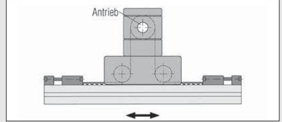
Zum Befestigen und Spannen der Zahnriemen an einem Führungsschlitten bzw. an einem Tragprofil (bei Verwendung der Gegenumlenkung 8). Pro Zahnriemenende ist ein Spannblock erforderlich. Die Anzahl der Gegenlager wird durch die jeweilige Anwendung bestimmt.
