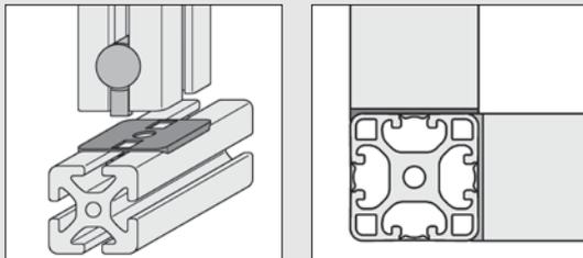
Der nach außen gewandte Spalt zur Profilkante wird durch die Radien-Dichtung 1R ausgefüllt.
