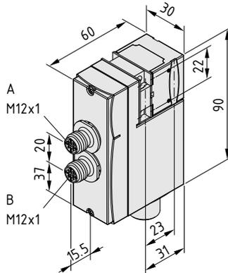
**Sicherheits-Verriegelung kompakt 2NC, 230 V AC**
