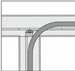
Eine zusätzliche Bearbeitung des Ständerprofils 8 80x40 mit einer Bohrung  $\varnothing 14$  mm ermöglicht die Durchführung von Kabeln und Schläuchen.
