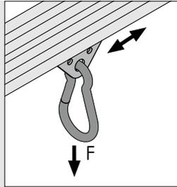
Mit den korrosionsbeständigen Karabinern wird eine einfache Aufhängung und der schnelle Wechsel der Werkzeuge ermöglicht:
