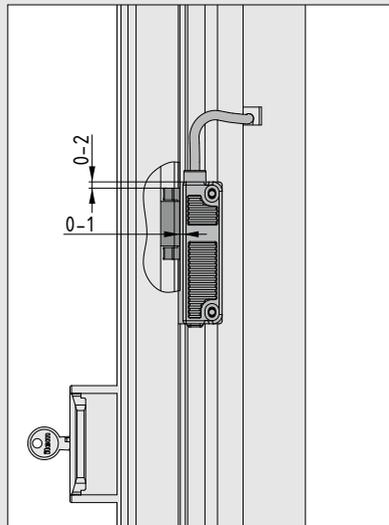
Der Betätiger muss in den vorgegebenen Abstandsmaßen zum Sensor positioniert werden, um das Schaltsignal auszulösen.
