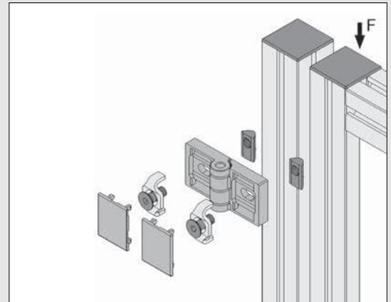
Befestigung des Scharniers X 8 Zn an Profilen der Baureihe X 8. Bei Profilen mit geschlossenen Nuten ist die Nutabdeckung zum Einsetzen der Nutensteine und Verdrehsicherungen zu entfernen.
