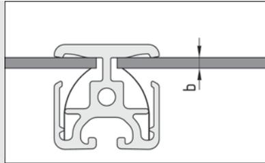
Eine besondere Klemmwirkung wird durch Verwendung von Klemmprofil-Band 8 30x0,15 E, Art-Nr. 0.0.440.48 erreicht. In diesem Fall müssen die Klemmprofile zuerst auf das Flächenelement aufgeschoben werden. Der Rahmen wird anschließend mit Winkeln V 8 40 Zn verbunden.
