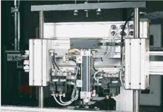
Kugelhülsenführungen können als kompakte Linearführungen in Profilkonstruktionen integriert werden.
