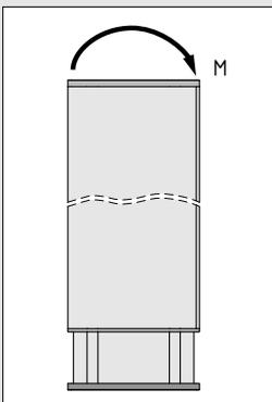
Bei der Auslegung von Arbeitstischen ist die Momentbelastung  $M_{\text{max}} = 140$  Nm des Tischsäulensatzes zu berücksichtigen.
