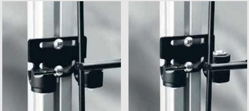
Die Stabmatte wird in vormontierte Stabmatten-Aufhängung eingehängt und anschließend mit weiteren Aufhängungen verschraubt. Empfohlener Abstand der Aufhängungen: 3 Feldhöhen entsprechend 600 mm.
