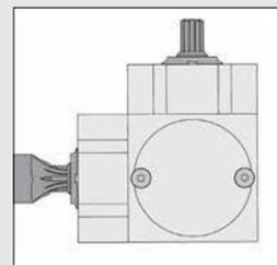
Veränderung der Anschlussgeometrie von Vielkeilnabe zu Vielkeilwelle oder Vollwelle  $\varnothing 30$  mm durch Verwendung der Verbindungswelle U-WG oder der Adapterwelle.
