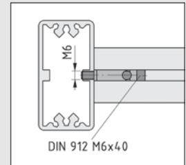
Zur seitlichen Verbindung von Teleskop-Profilen 8 80x40 wird empfohlen, das Profil im Bereich der zentralen Rippe mit Gewinden M6 zu versehen und Automatik-Verbindungsätze 8 zu verwenden.
