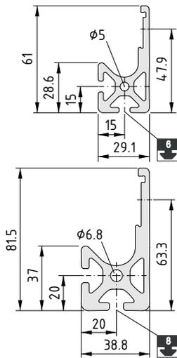
**C-Schiene, Schlittenprofil 6**
