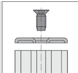
Selbstfurchende Schraube zur Befestigung der Abdeckkappen Zn in der Kernbohrung der Profile 8.
