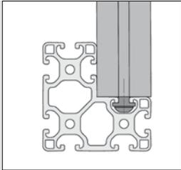
Die Innenecke der Winkelprofile ist mit einem Freistich versehen. Scharfkantige Anbauteile können daher beidseitig flächenbündig verschraubt werden.
