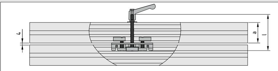
Die Anbringung der Gleitschlitten an Profilmuten 8 sollte stets unter Verwendung der konfektionierten Befestigungssätze erfolgen, Art.-Nr. 0.0.619.62.
