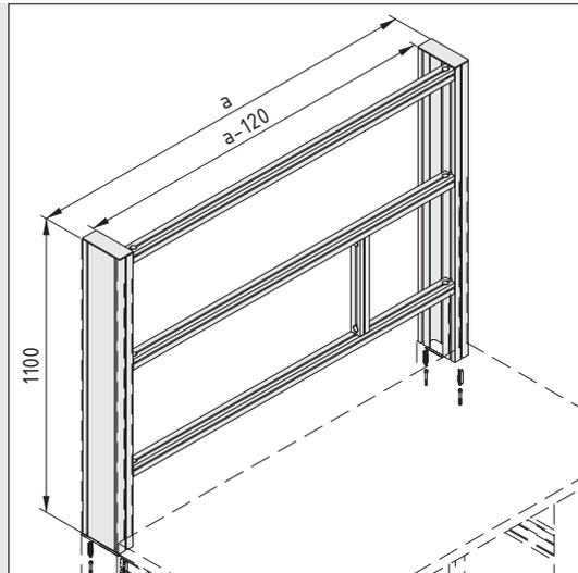
Das Profil 8 160x60 4N K56 ist ideal zum Bau von Tischaufsätzen für die Tische E, 2F, 4E und F2F.
