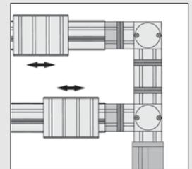
Parallelanordnung von Spindel-einheiten in Verbindung mit Winkelgetrieben.
