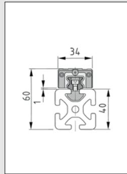
Die Befestigung der Führungsschiene PS 4-15 erfolgt auf der Profilvernut 8. Hierfür ist die Schiene entsprechend geformt und zentriert sich selbsttätig beim Verschrauben gegen das Nutenprofil 8 Al M4-60.
