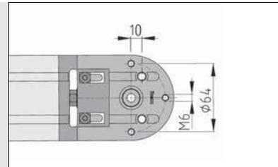
Der Antrieb der Kette kann direkt an den Kettenumlenkungen oder an der Ketten-Gegenumlenkung erfolgen. Die Kettenräder der Kettenumlenkungen sind mit Vielkeilnabe VK14 oder mit Bohrung zur individuellen Bearbeitung erhältlich. Durch Verwendung der Vielkeilwelle VK14 sind die modularen Zubehörelemente (Synchronwellen) uneingeschränkt einsetzbar.
