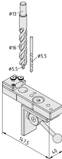
**Bohreinheit, Bohr-Adaptersatz 6**
