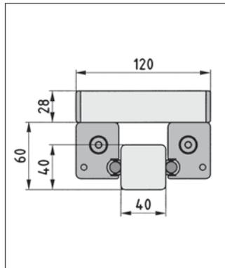
Grundkonstruktion aus Profilen der Baureihe 8 mit Rollenführung 8 auf Welle D10.
