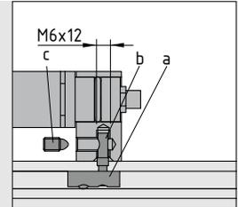
Montage der Maschinenleuchten LED am Profil 8 mit dem beiliegenden Befestigungselementen:
