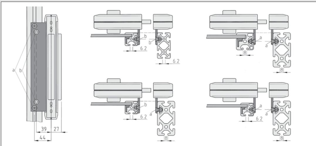
Die benötigten Längen des Standard-Profilzylinders auf der dem Flächenelement zugewandten Seite ist unter Berücksichtigung der Dicke des Flächenelementes, des eingesetzten Rahmenprofils und der Kombination von Ständer- und Rahmenprofil zu ermitteln.
