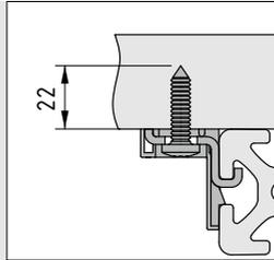
Eine Bearbeitung der Tischplatte ist nicht erforderlich. Die selbstbohrende Schraube kann mit einem Schrauber (Klingeneinsatz TX30) direkt in die Tischplatte geschraubt werden. Der Toleranzausgleich erfolgt durch ein Langloch in der Tischplattenbefestigung 8.
