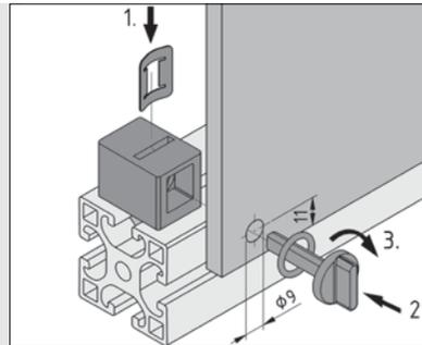
Rastmultiblocke können für Flächenelemente beliebiger Dicke (bis 8 mm) verwendet werden. Die zwei unterschiedliche Einbaulagen (Abstand zur Profilkante 4 oder 8 mm) ermöglichen die Anpassung an die Flächendicke. Die Rastfeder ist entsprechend der Belastungsrichtung in den Rastmultiblock einzusetzen: die Wölbung der Feder muss der Einsteckrichtung des Knebels entgegen gerichtet sein. Das Verriegeln des Zapfens spannt zugleich die Feder.
