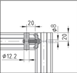
Das Widerlager der Verbindung bildet ein Bolzen mit Gewindebohrung, der in eine Querbohrung des Profils ( $\varnothing$  12,2 mm) eingeschoben wird.
