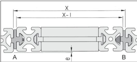
Gleitführung L (A = Loslager) und Gleitführung F (B = Festlager) als Führungselemente, befestigt am beweglichen Bauteil.
