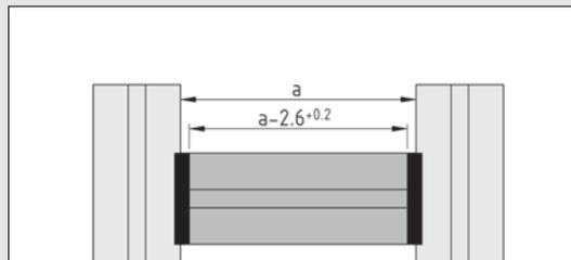
Bei der Ermittlung der Länge von Profilen zwischen zwei begrenzenden Streben ist die Dicke der Radien-Dichtungen je Seite zu berücksichtigen.
