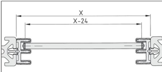
Der Aluminium-Rollladen wird aufgebaut aus Lamellenprofilen Al, zwischen die jeweils Lamellenisolierungen eingeschoben werden. Jede Lamelle muss an beiden Enden mit Lamellengleitschuhen versehen werden.
