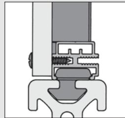
Winkelschraubleiste in Verbindung mit Dichtband 6x3 sk und Schalldämmmaterial 20 mm.
