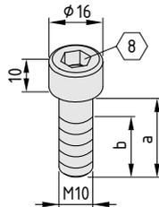
**Zylinderschraube DIN 912 M10x60**
