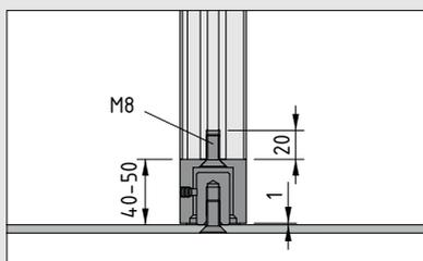
Der Stellwandadapter D40 ermöglicht die individuelle Höhen- und Winkelverstellung jedes Stellwandsegments.
