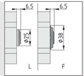
Geeignet zur Kombination mit allen item Linearführungen. Die Führung der Muttermitnahme muss durch die angebaute Linearführung erfolgen. Kardanische Aufhängung der Mutter zur Vermeidung von Verspannungen bzw. Fehlbelastungen der Spindel-Flanschmutter-Kombination.
