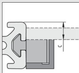
Die Länge der Befestigungsschraube ist in Abhängigkeit von der Dicke des Flächenelementes und der Verwendung des Höhenausgleichs zu bestimmen.
