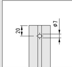
Position der Durchgangsbohrungen für den Schraubendreher.
