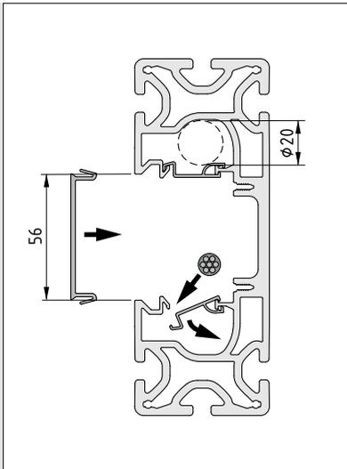
Kabel bis 20 mm Durchmesser können auch nachträglich in das Profil 8 160x60 4N K56 eingesetzt werden. Die Verriegelung 40 Kanalprofil K schützt den innenliegenden Kabelkanal.
