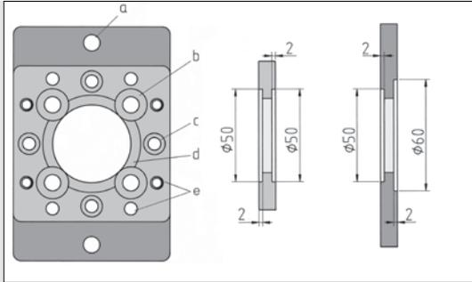
Adapterplatten zur universellen Verbindung von Antrieben, Winkelgetrieben, Umlenkungen und Profilen untereinander.
