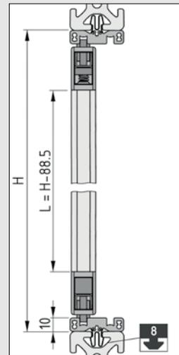
Die Segmente einer Falldür werden mit dem Rollensatz für Eckverbinder 8 32x18 (0.0.494.74) versehen. Sie laufen im Schiebetür-Führungsprofil 8 40x10 (0.0.495.13), was bei der Berechnung der Höhe des Türrahmens beachtet werden muss.
