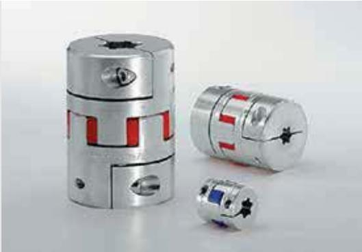
Zwischen den mechanischen Antriebselementen (Zahnriemenumlenkungen, Ketten- und Kugelgewindetriebe, Winkelgetriebe) und dem Antrieb bietet sich der Einsatz von Kupplungen zur Dämpfung und zum Ausgleich von Winkel Fehlern sowie radialem bzw. axialem Versatz an.
