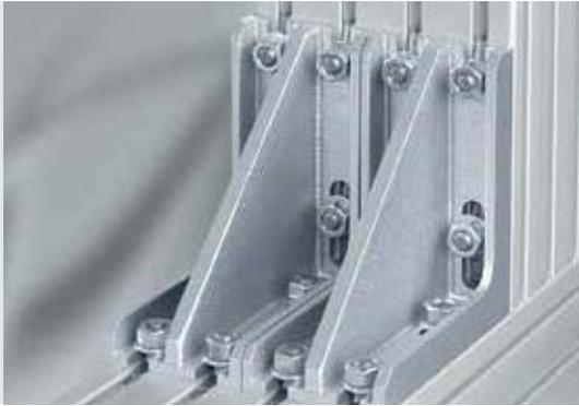
Der Winkel 8 160x160 St M12 ist vorgesehen zur Verschraubung mit den Verbindern 8 M12. Die Verwendung eines Bolzens M12 an Profilenuten 8 ermöglicht eine besonders belastbare Verbindung der Profile. Alternativ kann der Winkel 8 St M12 auch mit Schrauben und Nutensteinen 8 St M8 verschraubt werden.
