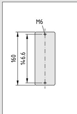
Die Gewindebohrungen M6 in den Anschlussplatten sind für die Befestigung von Profilen 8 160x60 4N E mittels Automatik-Verbindungssätzen 8 geeignet.
