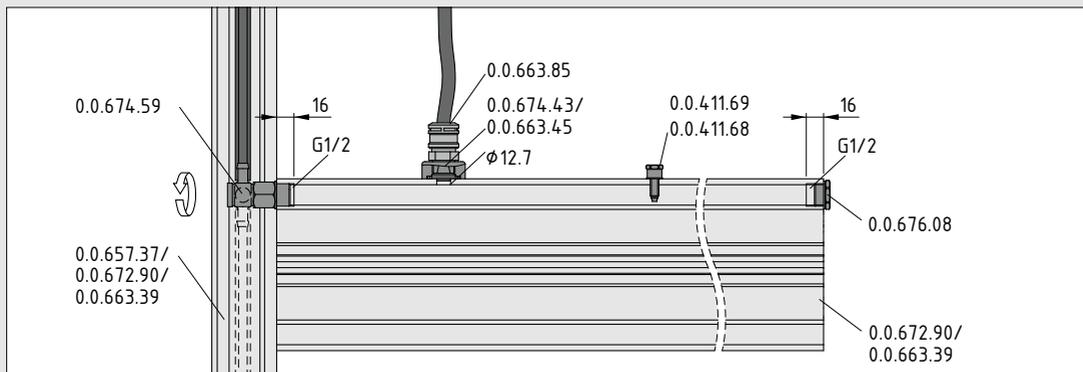
Anwendungsbeispiel für den waagrechten Einsatz eines Installationsprofils mit verschiedenen Pneumatik-Komponenten.
