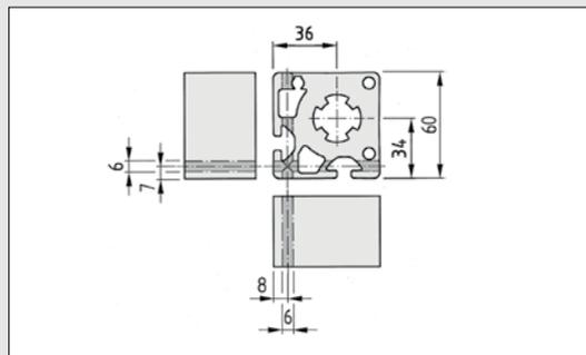
Bei Bedarf können die Blöcke in den gekennzeichneten Bereichen verstiftet werden.
