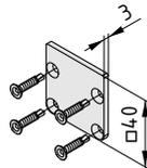
**Rollenschiene 8 Abdeckplatte 40x40**
