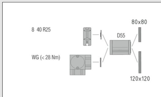
Die Kupplung D55 ist durch die Anschlussmaße und den zulässigen Drehmomentenbereich ( $M_D < 50 \text{ Nm}$ ) besonders für die Verwendung mit der Zahnriemenumlenkung 8 40 R25 mit Vielkeil VK14 (Zentrierung D50-D22) und optional den Winkelgetrieben WG (Zentrierung D50-D50: Drehmomentgrenze 28 Nm beachten!) geeignet.
