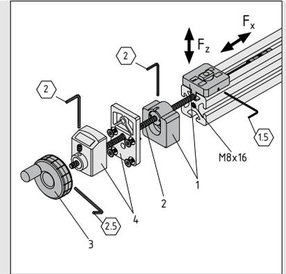
Die optionalen digitalen Positionsanzeigen (4) (mechanisches oder elektronisches Zählwerk) ermöglichen eine weggenaue Positionseinstellung der Zustellung.
