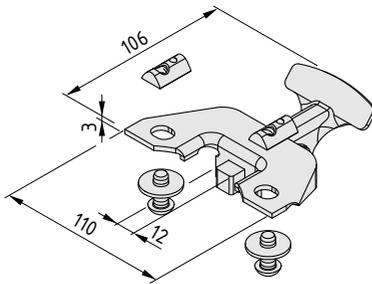
**Richtungsfeststeller für Lenkrolle D100/D125 140x110**
