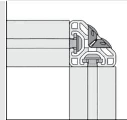
Graue Abdeckkappen verschließen die Bohrungen in den Seitenflächen der Profile mit geschlossenen Nuten unauffällig farblich an das Aluminium angepasst.
