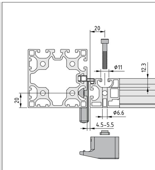
Das Türschloss X 8 Zn nutzt die Profilnut im Türspalt zur verdeckten Befestigung. Es kann ergonomisch in optimaler Greifhöhe angebracht werden. Alle Befestigungsschrauben sind bei geschlossener Tür sicher abgedeckt.
