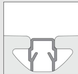
Mit der geschlossenen Seite nach oben eingesetzt, schützt das Abdeck- und Einfassprofil die Nut vor Verschmutzung.
