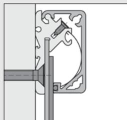
Das Trägerprofil kann auch mit einer Senkschraube an einer beliebigen Fläche befestigt werden.
