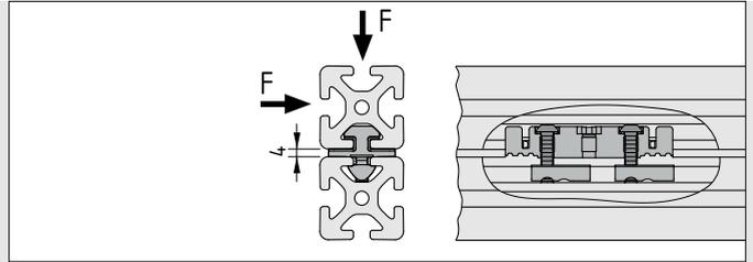
Die Anbringung der Gleitschlitten an Profilmuten 8 sollte stets unter Verwendung der konfektionierten Befestigungssätze erfolgen.
