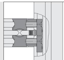
Die Kontaktstifte ESD sind Bauteile für elektrisch ableitfähige Profilverbindungen.
