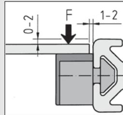
Einbauempfehlung für das Flächenelement und zulässige Belastungskräfte für die Multiblöcke PA.
