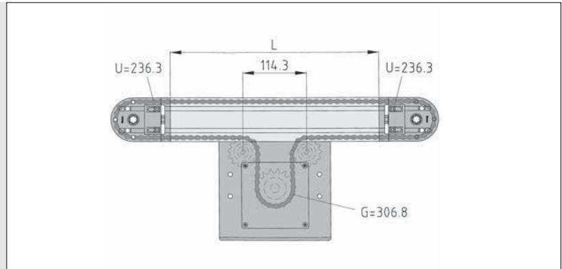
Bestimmung der Kettenlänge für einen Kettentrieb mit zwei Kettenumlenkungen 8 80 und einer Ketten-Gegenumlenkung 8:
