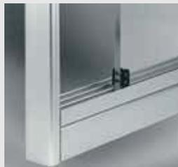
Durch geeignete Anbringung der Schiebetür-Mitnehmer muss der Handschutz sichergestellt werden, um das Entstehen einer Klemmstelle an Handgriffen oder Griffmulden zu vermeiden.
