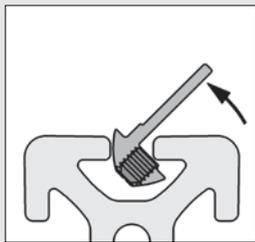
Die Winkelleiste wird in die Nut eingeschwenkt und mit Gewindestiften fixiert. Die Winkelleiste 8 Al 16 M5, 8 Al M6 und 10 Al M6 sind bereits mit den erforderlichen Gewindebohrungen und -stiften versehen.
