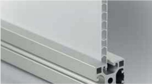
Wenn es schnell gehen muss oder an eine Trennwand keine hohen Sicherheitsanforderungen gestellt werden, sind Stegplatten die richtige Wahl. Die leichten Flächenelemente aus pflegeleichtem Polypropylen lassen sich mit einem Messer passend zuschneiden und mit wenigen Handgriffen befestigen. Damit entsteht im Handumdrehen beispielsweise ein Boden unter einer Rollenbahn oder ein Spritzschutz zwischen Profilen.
