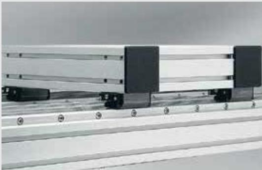
Führungssysteme mit parallelen Schienen auf einem einzigen Tragprofil können durch die spezielle Befestigungsgeometrie der Schiene auf der Profilvernut ohne aufwändige Ausrichtmaßnahmen aufgebaut werden. Der Einsatz paralleler Schienen auf unabhängigen Profilen oder auf anderen Tragkonstruktionen erfordert den für Profilschienenführungen typischen Aufwand an Ausrichtung und Befestigung (Bearbeitung der Anschraubflächen, Einsatz von Parallelstücken o. Ä.).
