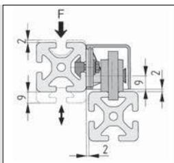
Durch die Langlöcher des Flansches ist die Höhenverstellung der Rolleneinheit möglich.
