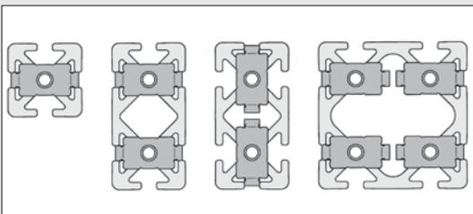
Je nach Einbaulage der Profile können die Standard-Verbindungsbleche in der erforderlichen Richtung angeordnet werden. Die Verbindung großer Profile mit hohen Belastbarkeiten kann mit einer entsprechend größeren Anzahl von Standard-Verbindungen ausgeführt werden.
