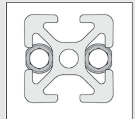
Der Automatik-Verbindungssatz 5 sollte so eingedreht werden, dass die Abflachung am Gewinde bündig zur Profilaußenkante ist.
