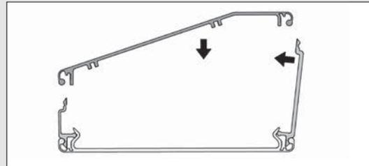
Trägerprofile 80-45° und 160-20° sind als Deckel eines modularen Kanals besonders geeignet zum Bau von Bedienpulten beliebiger Länge, Tastergehäusen o. Ä.
