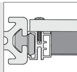
Das Schalldämmmaterial wird mit einem Flächenelement verklebt. Die Befestigung des Flächenelementes im Profilrahmen sollte möglichst entkoppelt erfolgen.
