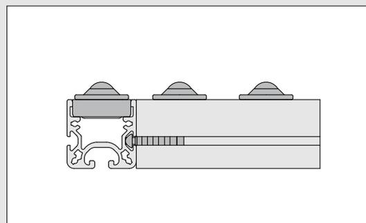
Verbindung zweier Rollenschienen 8 40x40 durch Verbindungselemente und Profilmuten 5 und 8.
