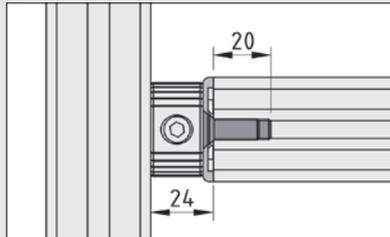
Zum Einsatz des Klick-Verbindungssatz 8 90° muss die Kernbohrung des stirnseitig verbundenen Profils 8 mit einer Bohrung M8x20 versehen werden. Das Abstandsmaß zwischen der Profilstirnfläche und der Seite des zweiten Profils beträgt in diesem Fall 24 mm.
