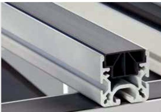
Gleitleiste zum Einsatz in die Rollenschiene 8 40x40. Der Einbau ist in 2 Höhenlagen möglich. Der ableitfähige Kunststoff verhindert elektrostatische Aufladung der Transportgüter.
