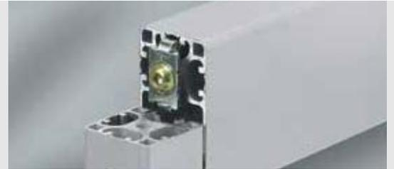
Der Standard-Verbindungsatz ESD wird verwendet wie ein herkömmlicher Standard-Verbindungsatz. Die spezielle Gestaltung der Verbindungsschraube bewirkt eine partielle Zerstörung der isolierenden Eloxalschicht der Profilverbindung und einen elektrischen Kontakt der verbundenen Profile.
