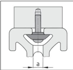
Mit den Nutscheiben können beliebige Bauelemente verdeckt (Schraubenkopf in der Profilmutter, Gewinde im Bauelement) befestigt werden.
