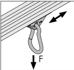
Mit den korrosionsbeständigen Karabinern wird eine einfache Aufhängung und der schnelle Wechsel der Werkzeuge ermöglicht:
