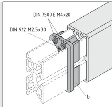
Zur Befestigung der Teleskop-Abdeckkappe (mit dem Teleskop-Profil 8 80x40) und der Teleskop-Gleitkappe (mit dem Teleskop-Innenprofil 8 80x40) liegen dem Teleskop-Anschlusssatz gewindeförmige Schrauben DIN 7500 bei.
