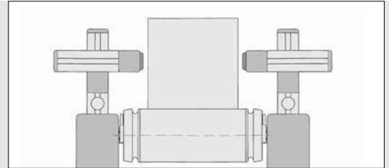
Die Gleitleiste 8 kann mit dem Gleitkeil 8 (er dient als Abschlusselement und Einführschräge) kombiniert werden.
