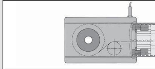
Variation der Austrittsmaße von 80 mm auf 40 mm durch interne Umlenkung des Zahnriemens. Der Zahnriemen wird dabei mit seiner glatten Rückseite über die Umlenkrollen geführt.
