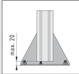
Ein Neigungsausgleich von Bodenunebenheiten ( $\pm 5^\circ$ ) wird durch die Langlochbefestigung im unteren Bereich des Stellfußes möglich.
