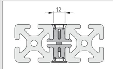
Anwendung des Parallel-Verbinder 8 Abdeckprofils:
