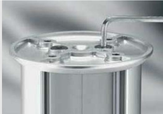
Der Flansch 8 D130 kann als Anschlussplatte für Tischsäulen mit dem Säulenprofil D110 verwendet werden. Er kann sowohl mit der Tischplatte, als auch mit einer Bodenplatte oder direkt mit dem Boden verschraubt werden.
