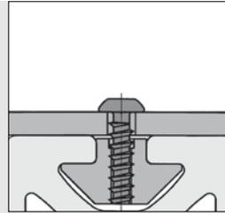
Speziell auf den Nutenstein 8 PA abgestimmt ist die Halbrundschrabe T4 von item. Diese Schraube formt im Kunststoffkörper ihr Gewinde selbst.
