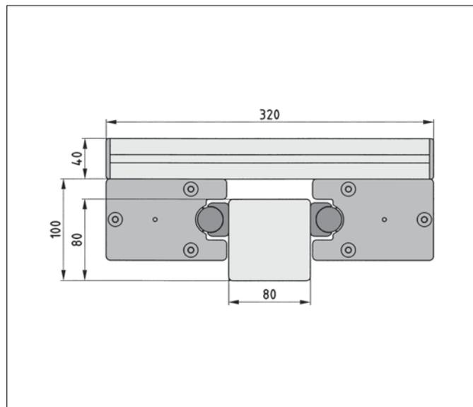
Grundkonstruktion aus Profilen der Baureihe 8 mit Rollenführung 8 auf Welle D25.
