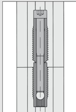
Eine zusätzliche Verdrehsicherung kann realisiert werden, in dem der Verbinder mit Innengewinde nur soweit in das Profil gedreht wird, dass das Ende des Verbinders in die gegenüberliegende Nut hineinragt. Dementsprechend weit muss der Verbinder mit Durchgangsbohrung eingeschraubt werden.
