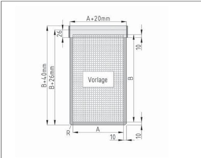
Ermittlung der Anzahl und Längen der Einzelkomponenten für den Bau von Vorlagehaltern als Klemmbrett.
