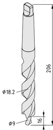
**Stufenbohrer, Zentral-Verbindung 10**
