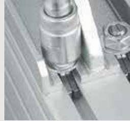
Zweiteiliger Verbinder zur hochbelastbaren Befestigung von Bauteilen an der Profilnut 8. Die Verbinderhälften werden an beliebiger Stelle in die Nut eingesetzt und dort zusammengefügt. Das integrierte Kugeldruckstück hält den Verbinder anschließend an seiner Position und erleichtert so das Verschrauben.
