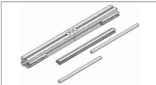
Bei Rollenführungen über 3 m Länge werden die Wellen, das Wellenklammerprofil und das tragende Profil mit den Schnittstellen versetzt zueinander montiert.
