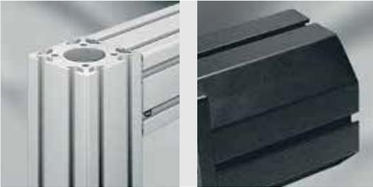
Das Profil 8 80x80-45° D60 ist Basis für die Kupplungsgehäuse 8 D30 und 8 D55, beim Kupplungsgehäuse 8 D80 wird das Profil 8 120x120-45° D87 eingesetzt. Mit den Profilen können Kupplungsgehäuse in besonderen Längen bzw. Gehäuse für Synchronwellen zwischen mechanischen Antriebselementen realisiert werden.
