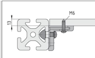
Bei ausreichender Dicke des Flächenelementes ist auch eine von außen unsichtbare oder nicht lösbare Befestigung mit dem Multiwinkel 12 von innen möglich.
