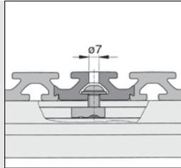
Mögliche Befestigungsvarianten (mittels Halbrundschrabe M8x16, Scheibe DIN 125-8.4 und Nutenstein 8 St M8) des Plattenverbundes mit der Rahmenkonstruktion.
