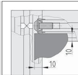
Der Standard-Verbindungssatz 8 K ist eine Spezialvariante des bewährten Standard-Verbindungssatzes. Er wird eingesetzt zur rechtwinkligen Verbindung von Profilen der Baureihe 8, bei denen die Profilmuten zur Aufnahme von Flächenelementen genutzt werden.
