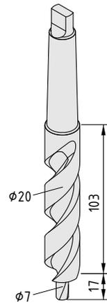
**Stufenbohrer, Universal-Verbindung 8, MK2**
