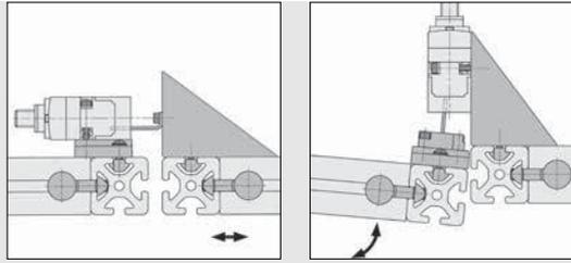
Der Befestigungssatz 6-8 ist geeignet zur universellen Befestigung der Sicherheits-Endschalter und -Verriegelung kompakt sowie des Betätigers an Profilen der Baureihen 6 und/oder 8. Über die Langlöcher ist eine individuelle Anpassung an die Betätigungsrichtung und die Lage der Elemente zueinander möglich.
