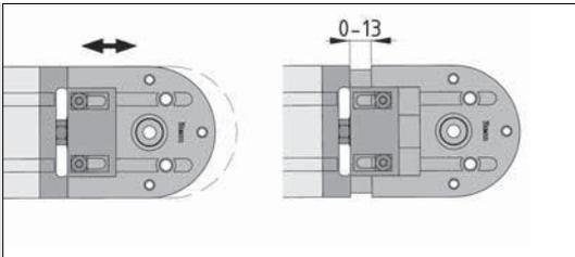
Integrierte Ketten-Spannvorrichtung durch Spannblock in der Kettenumlenkung.
