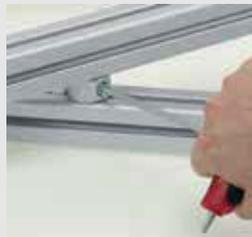
**Ausrichten** des KLICK-Verbindungssatzes und **Anziehen** der Spannschraube
