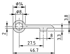
**Scharnierlappenprofil V 8 z leicht**
