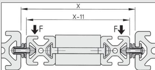
Die Nutrollen verbinden das Profil der Baureihe 8 mit dem bewegten Bauelement grundsätzlich ohne Mitterversatz.
