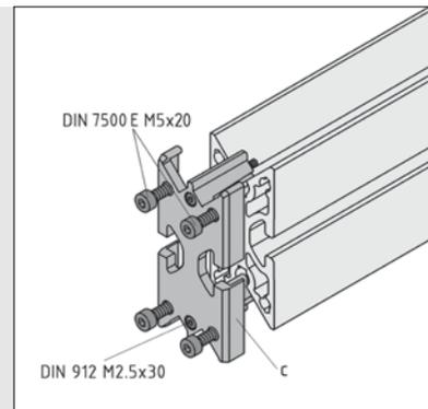
Nach dem Einschieben des Teleskop-Innenprofils werden die Gleitlager der Teleskop-Gleitkappe und -Abdeckkappe über die Schrauben M2,5x30 (SW 1,5) spielfrei eingestellt.
