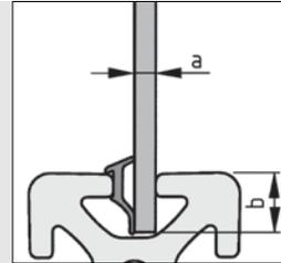
Das Montagewerkzeug erleichtert das lagerichtige Eindrücken des Dichtprofils in die Profilitut.
