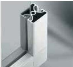
Der Klemmprofil-Verbinder kann grundsätzlich mit beliebigen Profilen 6 30x30 bzw. 8 40x40 und auch mit den Klemmprofilen 6 30x30 bzw. 8 40x40 kombiniert werden. Ein spezieller Freiraum im Klemmprofil-Verbinder macht das Ausklinken von Flächen, die in die Profalnuten eingesetzt werden sollen, unnötig.
