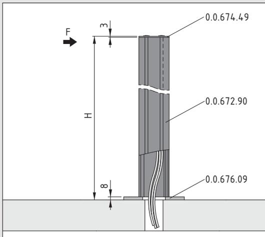
Maximales Drehmoment für Bodenbefestigung Installationsprofil 160x80, beispielhaft für gerissenen Beton C20/C25 in Verbindung mit dem Bodenbefestigungssatz M10x135 (0.0.485.82):
