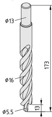
**Stufenbohrer, Universal-Verbindung 6**
