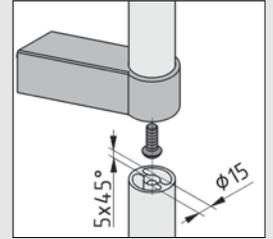
In das Sockelelement X D25 werden Profilabschnitte D25 einseitig oder von beiden Seiten her eingesteckt. Eine nicht benötigte Öffnung wird mit der beiliegenden Abdeckkappe verschlossen.
