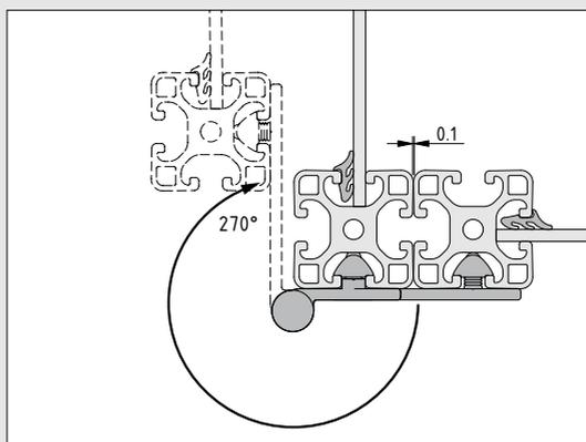
Die Scharniere Al FP0-270° besitzen unterschiedlich lange Scharnierlappen. Dies ermöglicht einen Öffnungswinkel von 270°. Die Aufsatzscharniere halten sowohl rahmenlose Flächen als auch Profilrahmen mit Flächenelement. Dank präziser Führung ohne Absenken des Türblatts ist die Montage nahezu ohne Türspalt zur Zarge kein Problem.
