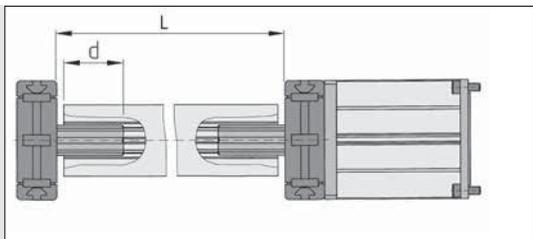
Anwendung einer Synchronwelle zur Verbindung von zwei Zahnriemenumlenkungen.
