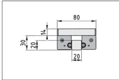
Grundkonstruktion aus Profilen der Baureihe 5 mit Rollenführung 5 auf Welle D6.
