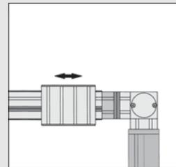
Direkte Anbindung des Winkelgetriebes WG mit Hilfe der Adapterplatte 80x80. Antriebe können mit den Kupplungsgehäusen an das Winkelgetriebe WG angebunden werden.
