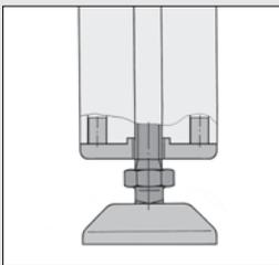
Die Klemmung der Fuß-Abdeckkappe erfolgt in den äußeren Profilhohlräumen des Profils 8 40x40 leicht.
