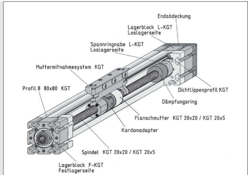
Der modulare Aufbau der Spindleinheiten KGT ohne komplexe Bearbeitung führt zu kurzen Lieferzeiten und stellt die einfache Montage und Wartung sicher.
