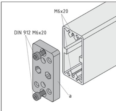
Der Teleskop-Anschlusssatz 8 80x40 beinhaltet alle Komponenten zur Anbindung des Teleskop-Profiles 8 80x40 sowie zum Bau eines Teleskops:
