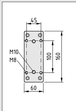
Die Gewindebohrungen M10 in den Bodenplatten sind für die Aufnahme von beliebigen Stellfüßen geeignet.
