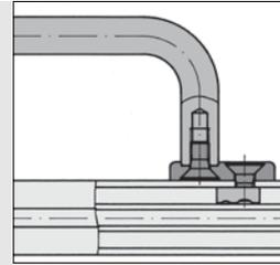
Die abgewinkelten Handgriffe sind besonders für Schiebe- und Schwenktüren geeignet, um die Quetschgefahr zu verringern.
