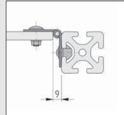
**Hinweis:** Bei Verschraubung des Scharniers St an Profile der Baureihe 8 wird die Verwendung von Nutensteinen 8 Zn M5 empfohlen.
