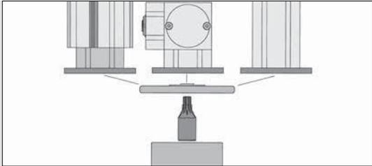
Anschluss beliebiger Antriebe an die Spindeleinheiten KGT, das Winkelgetriebe oder an Profile durch die Verwendung der Adapterwelle, der Adapterplatte 120x80 und des Adapterflansches Universal.
