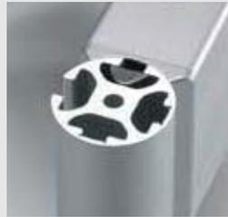
Bei der Verbindung eines Profils 8 mit rechteckigem Querschnitt an die Seitenfläche der Profile 8 D40 kann auch der Universal-Verbindungssatz 8 verwendet werden. Dabei ist zu beachten, dass wegen der Wanddicke des Adapters der Bohrungsabstand der Montagebohrung  $\varnothing 20$  mm für den Universal-Verbinder nur 18 mm betragen darf. Außerdem muss die Verdrehesicherung des Universal-Verbinders 8 entfernt werden.
