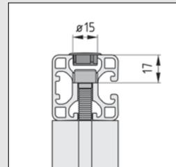
Durch die Abdeckkappe 8 D7-D40 kann die Durchgangsbohrung  $\varnothing$  7 mm für das Werkzeug der Standardverbindung 8 in Profilen 8 D40 mit geschlossenen Nuten verschlossen werden. Der graue Farbton ist auf die Oberfläche der naturfarbenen eloxierten Profile abgestimmt.
