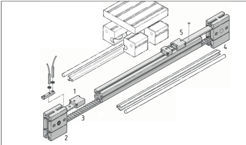
Zahnriementriebe sind besonders für hohe Geschwindigkeiten und große Hublängen geeignet.
