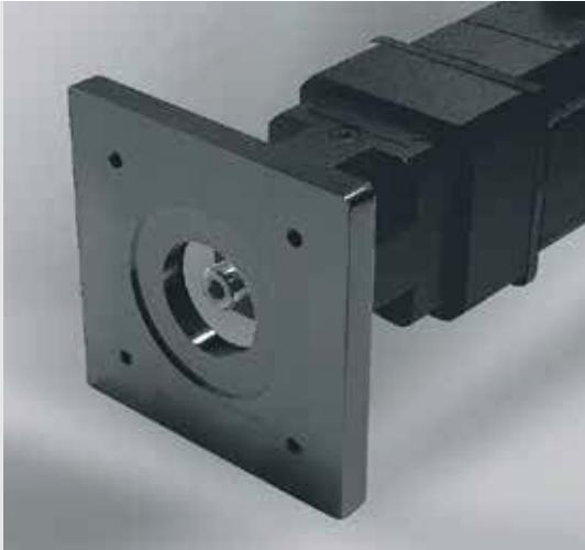
Neben der oben beschriebenen Verbindung der rotierenden Elemente müssen die Gehäuse der mechanischen Antriebselemente statisch mit den Antrieben verbunden werden. Dazu dienen die Kupplungsgehäuse, die in Länge und Durchmesser an die verschiedenen Kupplungen angepasst sind. Universelle Kupplungsplatten, die mit Befestigungsbohrungen und Zentrierdurchmesser für den jeweiligen Antrieb bearbeitet werden müssen, erlauben die Befestigung des Antriebs an das Kupplungsgehäuse.
