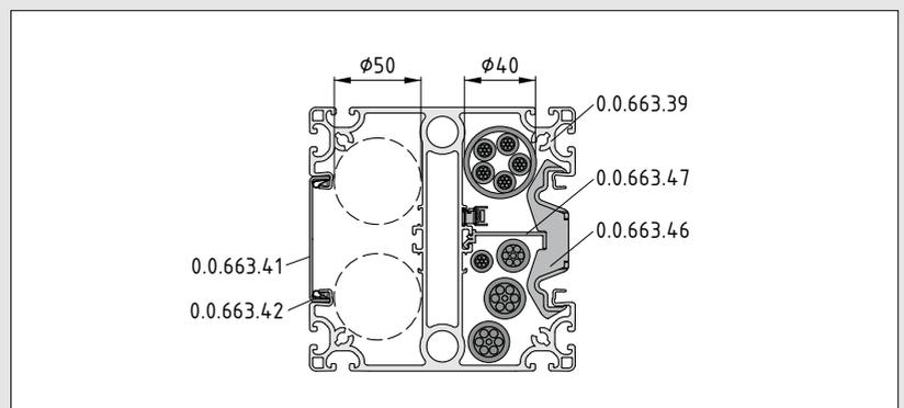
Montagebeispiel für das Installationssäulenprofil 8 160x160 K76 mit geteiltem Kanal mittels Trennprofil K76 K (0.0.663.47) und Trennprofil-Klipp K76 K (0.0.663.46). Der maximal verfügbare Freiraum im Kanal beträgt im Durchmesser 40 mm. Der maximal verfügbare Freiraum im Kanal ohne Trennprofil K76 K (0.0.663.47) und Trennprofil-Klipp K76 K (0.0.663.46) beträgt im Durchmesser 50 mm.
