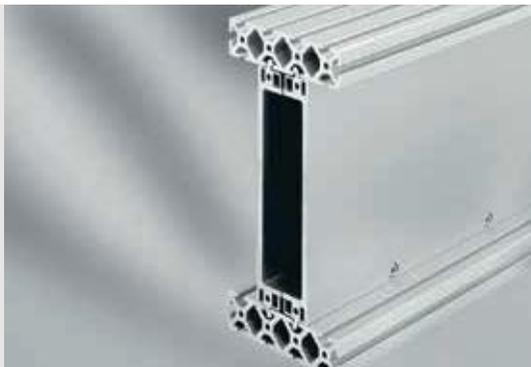
Die Verbindungsprofile 8 160 und 8 240 werden paarweise bearbeitet mit Bohrungen für die Befestigungsschrauben DIN 912-M8x60 und Sechskantmutter DIN 934-M8 ausgeliefert.
