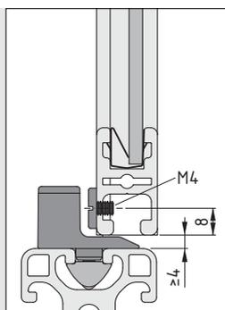
So hält die Tür von allein: Der Magnetanschlag für Klemmprofil 8 32x18 ist die ideale Ergänzung zum Klemmprofil 8 32x18 (0.0.373.67). Dieses ermöglicht die Konstruktion von Fenstern und Türen mit besonders schmalen Rahmen. Dabei hält es Flächenelemente in einer speziellen Nut des Profils durch Klemmfedern klapperfrei fest.
