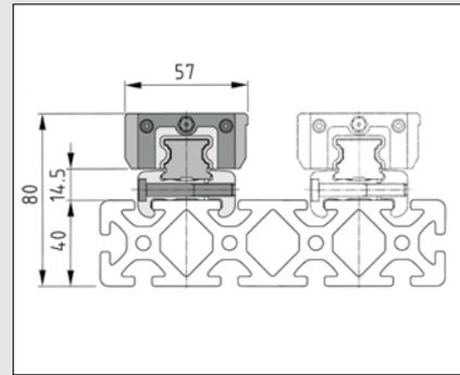
Eine Führung PS 4-25 wird mit mindestens einem Führungswagen, Führungsschiene und einer Schienenklemmung auf einem Trägerprofil aufgebaut.
