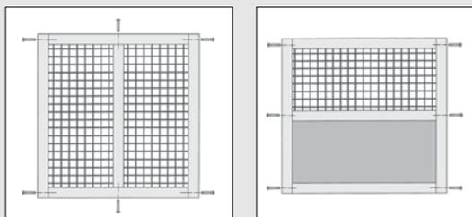
Bei der Rahmengestaltung muss darauf geachtet werden, dass waagerechte Klemmprofile ausschließlich an der Stirnseite angebinden werden. Die vertikalen Profile erhalten eine entsprechende Bohrung.
