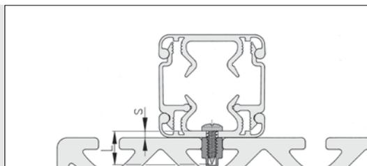
Befestigungsbeispiel eines Kabelkanals mit Schraubleiste 8 Al und Blechschrauben DIN 7981 St 4,2x13. Die benötigte Schraubenlänge L muss in Abhängigkeit von der Werkstückdicke s ausgewählt werden.
