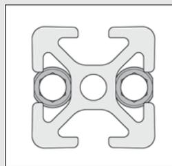
Der Automatik-Verbindungsatz 5 sollte so eingedreht werden, dass die Abflachung am Gewinde bündig zur Profilaußenkante ist.
