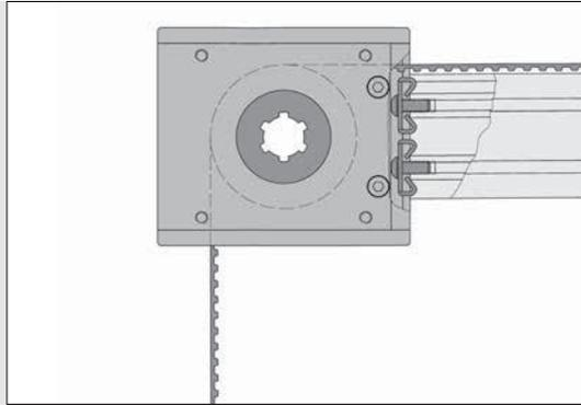
Anbindung der Zahnriemenumlenkung 8 80 R50 II bei einer Profilhöhe von 120 mm (Rückführung des Zahnriemens im Profilhohlraum) oder bei einer Profilhöhe von 80 mm mit Standard-Verbindungssätzen 8. Hierfür kann die Zahnriemenumlenkung einfach demontiert, am Profil befestigt und anschließend wieder montiert werden. Das Austrittsmaß des Zahnriemens beträgt 80 mm.
