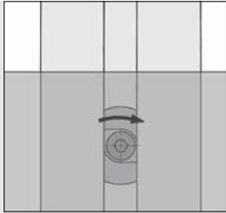
Der Nutenstein PA kann bei Bedarf mit der Schraube am zu befestigenden Bauteil vormontiert und an einer beliebigen Stelle in die Profilkant eingesetzt werden.
