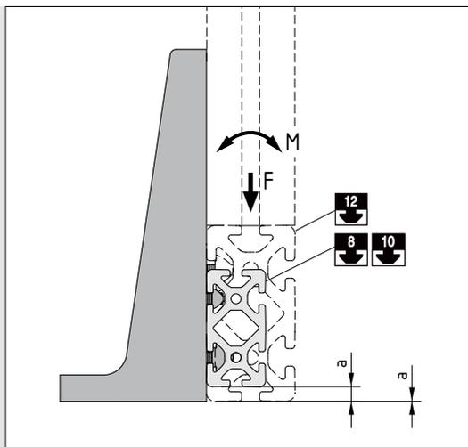
Die Langlochbefestigung zur Profilsseitenfläche ist auf die Rastermaße der Baureihen 8, 10 und 12 ausgelegt.
