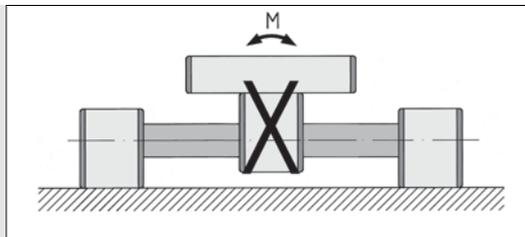
Die Wellenklemmblocks dienen der Aufnahme und Klemmung der Wellen. Die Klemmung erfolgt über die entsprechenden Gewindestifte.
