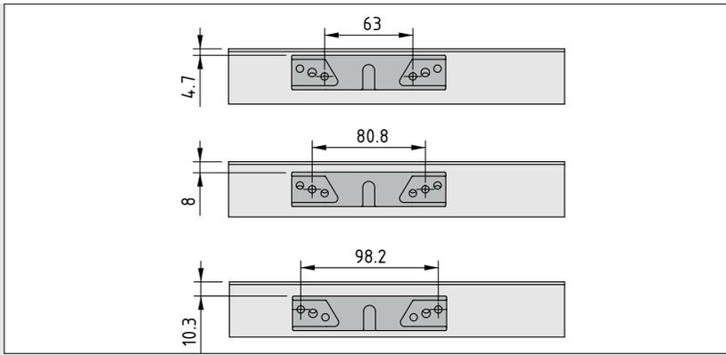
Bearbeitung des Profils M W 40x25x2 E für maximalen Verstellweg des Laufwagens
