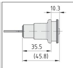
Einbaumaße im verriegelten und geöffneten Zustand.
