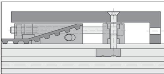
Der Zahnriemenspanner Niederhalter wird gemeinsam mit dem Gegenlager verschraubt. Durch die Bohrungen werden die Spannschrauben des Zahnriemenspanners betätigt.
