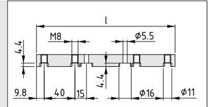
Die erforderliche Länge des T-Nutensteins (l) ist abhängig von der Länge des Schlittens (L).
