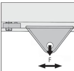
Als Endanschlag wird die Verwendung eines Nutensteins empfohlen, der mittels Gewindestift in der Nut festgesetzt wird.
