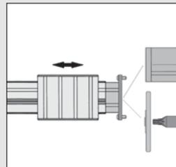
Direkte Anbindung von Antrieben mit der Adapterplatte 120x80. Adaptierung beliebiger Antriebe durch Einsatz der Adapterwelle und des Adapterflansches Universal.
