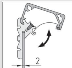
Schwenken des Deckelprofils zum Öffnen und Schließen des Vorlagenhalters. Die Federbleche fixieren den Deckel in beiden Endlagen. So wird die Vorlage durch einfaches Zuklappen des Deckelprofils fixiert.
