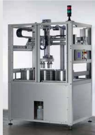
Durch Profile der Baureihe X entstehen elegante Konstruktionen mit geschlossenen Oberflächen. Der minimierte Kantenradius sorgt für übergangslose Verbindung zwischen den Profilen ohne vorstehenden Kanten. Das gibt Schmutz und Ablagerungen keine Chance. Auch optisch ist die Baureihe X ein Gewinn.
