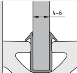
**Hinweis:** Zur Montage wird empfohlen, das Einfassprofil 8 mit Seifenwasser zu benetzen. Es wird dann auf das Flächenelement aufgesetzt und in die Profilnut eingeschoben. Der Profilrahmen wird um die Scheibe herum geschlossen.
