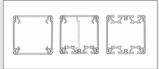
Bei gleichen Außenmaßen können durch die Wahl der Lage der Träger- bzw. Wandprofile unterschiedliche Kanäle aufgebaut werden. Dabei kann der Kanal von verschiedenen Seiten geöffnet und geschlossen werden.
