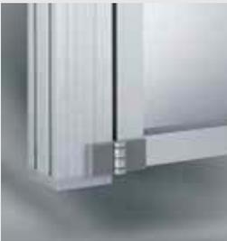
Scharniere X 8 werden bei höheren Belastungen (große Klappen, Türen etc.) an Profilen der Baureihen X 8 verwendet. Die Scharniere X 8 Zn sind links und rechts verwendbar, die Befestigung kann an den Profilaußenflächen oder stirnseitig erfolgen. Die integrierte Verdrehsicherung zur zusätzlichen Fixierung in der Nut kann bei der Verschraubung des Scharniers X 8 Zn an ebenen Flächen weggelassen werden.
