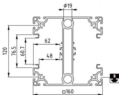
**Installationssäulenprofil 8 160x160 K76**
