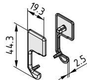
**C-Schiene, Schienenprofil-Abdeckkappensatz 6**
