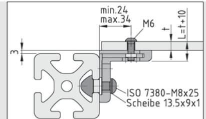
Befestigung des Flächenelementes mit Durchgangsbohrung über eine Schraube M6 in der Vierkantmutter des Multiwinkels 12 Zn.
