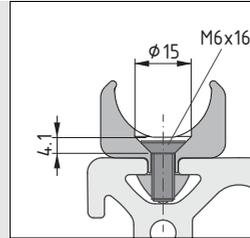
Das Wellenklemmprofil 8 D25 muss mit Senkschrauben DIN 7991 - M6x16 und Nutenstein 8 M6 St an der Profilnut verschraubt werden. Die Wellenklemmprofile D25 sind mit Befestigungsbohrungen im Abstand von 200 mm versehen.
