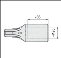
Die Adapterwelle nutzt zur Übertragung des Drehmomentes nur die halbe Nabenbreite der Zahnriemenscheiben R25. Bei Wechsellast sind die Drehmomentwerte der Zahnriemenumlenkungen mit Adapterwellen entsprechend zu reduzieren.
