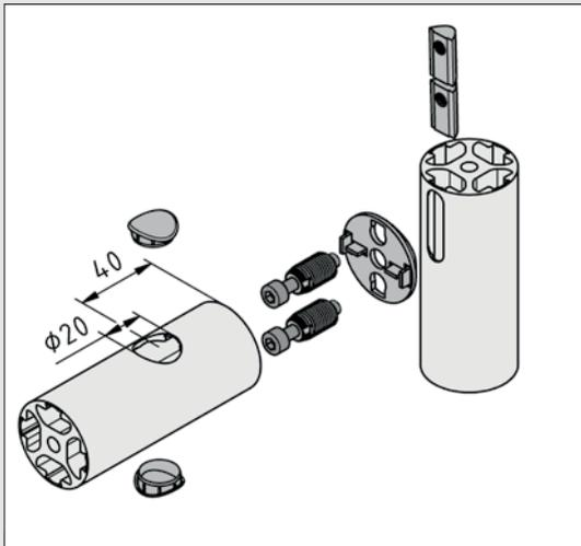
Bei Profilen mit offenen Nuten ist mit diesem Automatik-Verbindungssatz jedoch keine Profilbearbeitungen notwendig. Der selbstschneidende Automatik-Verbinder wird einfach von der Stirnseite in die Profilvernut eingeschraubt.
