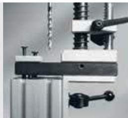
Durchgangsbohrung und Gewinde für den Standard-Verbindungssatz.
