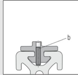
Erforderliche Bearbeitung und Befestigungselemente zum Festsetzen einer Gleitführungsleiste beliebiger Länge auf der Loslagerseite.
