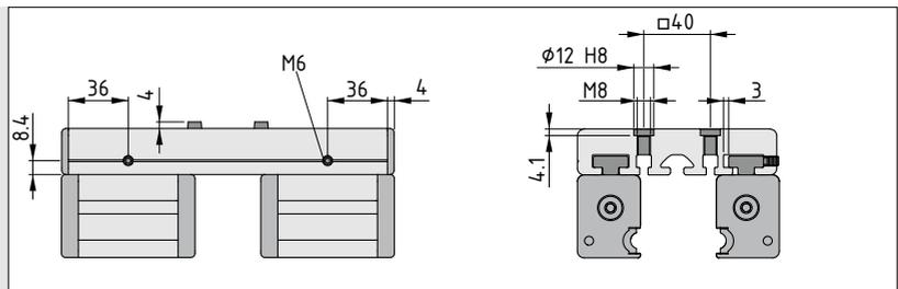
Notwendige Bearbeitung der Schlittenprofile LRF 8 in individueller Länge. Zur besseren Orientierung dienen die seitlichen Bohrriefen. Die Schlittenprofile erlauben frei geplante Befestigungsbohrungen. Der Einsatz von Positionierhülsen erfolgt bei Bedarf.
