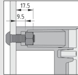
Der Handgriff X 160 PA ist mit Befestigungsmöglichkeit von vorn oder hinten (verdeckt) versehen und besonders geeignet für Schiebe- und Schwenktüren.
