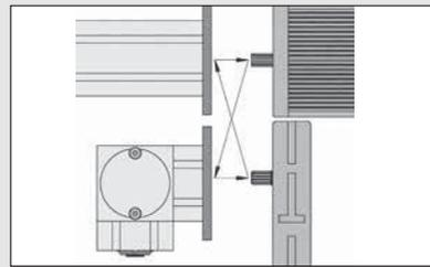
Anbindung von Antrieben (evtl. mit Adapterflansch Universal) und Zahnriemenumlenkungen an das Winkelgetriebe mit Adapterplatten.
