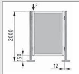
Eine Montage bzw. Aufhängung von vorne ermöglicht eine spaltfreie Montage der Rahmen bzw. Flächenelemente.
