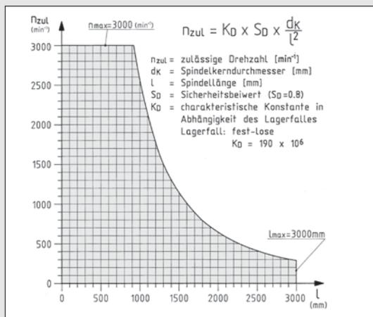
Der Antrieb der Spindleinheit KGT ist sowohl an der Fest- als auch an der Loslagerseite möglich. Durch geeignete Wahl der Festlagerseite kann die Hauptbelastung der Spindel als Zugbelastung ausgelegt werden. Die maximale Verfahrgeschwindigkeit der Spindleinheiten ist von der Spindellänge abhängig (siehe nebenstehendes Diagramm). Für Druckbelastung ist eine Betrachtung des Knickverhaltens der Spindel notwendig.
