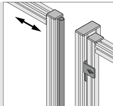
Im Bereich von Schutz- und Trennwänden, bei denen die Aufhängung 8/Türanschlag 8 (Spaltbreite 25/28 mm) verwendet wird, kann das Anschlagprofil 8 20x18 zur Reduzierung der Spaltbreite eingesetzt werden.
