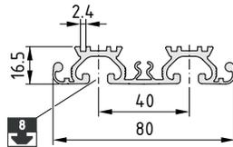
**Trägerprofil 80 mit Nuten 8**
