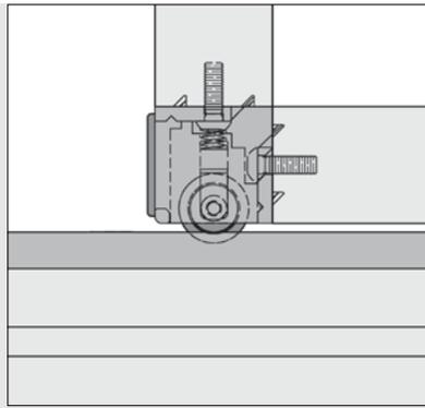
Der Rollensatz 32x18 wird in die Eckverbinder der bereits montierten Klemmprofil-Rahmen eingesetzt. Zur Führung eines Schiebetürblatts ist in jedem Verbinder ein Rollensatz einzubauen.
