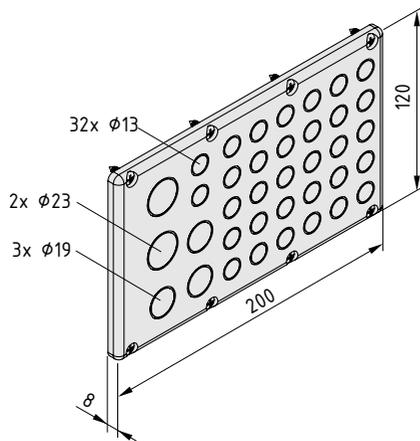
**Elektronikgehäuse-Deckel 8 200x120**
