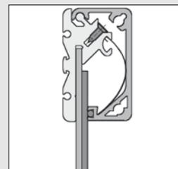
In allseitig geschlossenen Vorlagenhalter-Rahmen kann eine Schutzscheibe eingesetzt werden. Diese wird ebenfalls durch das Deckelprofil gehalten.
