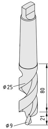
**Stufenbohrer, Universal-Verbindung 10**
