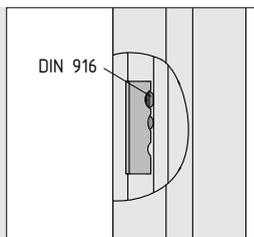
Der Nutenstein F verbindet die Vorteile des Nutenstein St mit den Anforderungen an ESD-fähige Anlagen. Er stellt eine dauerhaft leitfähige Verbindung zwischen dem Nutenstein und dem Profil sicher. So entsteht ohne Zusatzelemente eine elektrisch ableitfähige Profilverbindung. Möglich wird dies über die partielle Unterbrechung der elektrisch isolierenden Eloxalschicht der Profile im Nutgrund.
