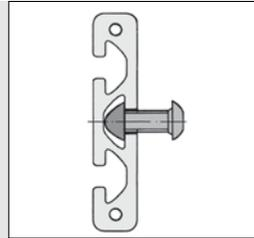
Bei Verwendung der mittleren Nut des Profils 8 80x16 ist an der vorgesehenen Befestigungsposition eine Durchgangsbohrung anzubringen.
