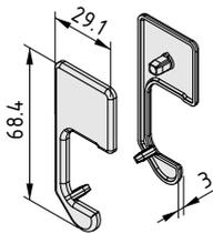
**C-Schiene, Schienenprofil-Abdeckkappensatz 8**
