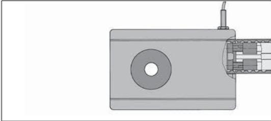
Anbindung der Zahnriemenumlenkung 8 80 R25 bei einer Profilhöhe von 40 mm mit Universalverbinder 8 und Spezialnutenstein. Bei einer Profilhöhe von 80 mm wird der Spezialnutenstein an der Sollbruchstelle getrennt.
