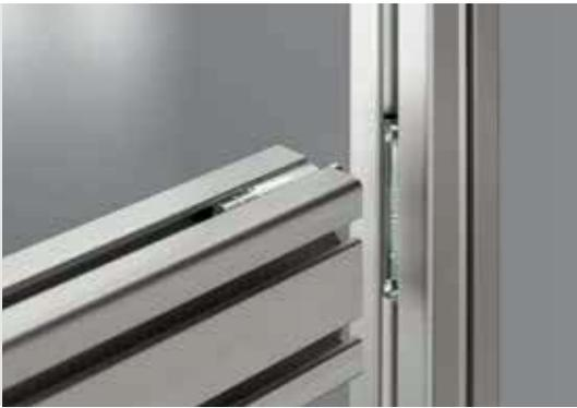
Automatik-Verbinder mit Doppelnutstein gibt es in kompletten Sätzen für die Nut 8 (passend zu den Profiltbreiten 40 und 80 mm), die Nut 6 (Profiltbreiten 30 und 60 mm) und die Nut 5 (Profiltbreite 20 mm).
