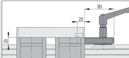
Die besondere Gestaltung der Schlittenklemmung 8 schwer verhindert die Verspannung der Führung in Folge der Klemmwirkung.
