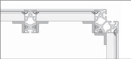
Die Verbindung der Klemmprofile leicht erfolgt über den Winkel V 8 40 Zn.
