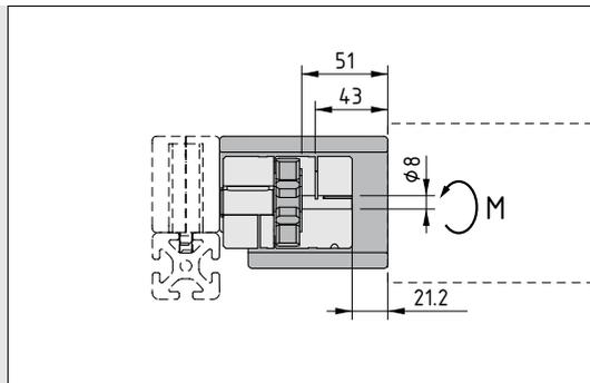
item bietet auch beim Zahnstangenantrieb die freie Antriebsauswahl. Dafür verfügt der Anschlussatz über eine universelle Kupplung zum Anschluss beliebiger Motore. Diese werden direkt mit dem Anschluss-Gehäuse verbunden.
