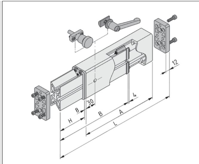
Das Teleskop-Innenprofil 8 80x40 (Länge B) sollte um 20 mm kürzer als das Teleskop-Profil 8 80x40 (Länge A) sein, um vollständig in das montierte Teleskop eingeschoben werden und den Hub H maximal nutzen zu können. Max. Belastung in Teleskoprichtung: 750 N
