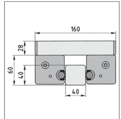
Grundkonstruktion aus Profilen der Baureihe 8 mit Rollenführung 8 auf Welle D14.
