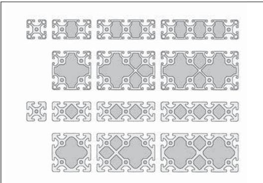
Voraussetzung für die Nutzung der Profil-Hohlräume als Pneumatikleitungen ist die Verwendung geeigneter Verbindungselemente z. B. Pneumatik-Universal-Verbindung. Auch der Automatik-Verbindungsatz ist zur Verbindung von Profilen geeignet, die als Pneumatik-Leitung genutzt werden.
