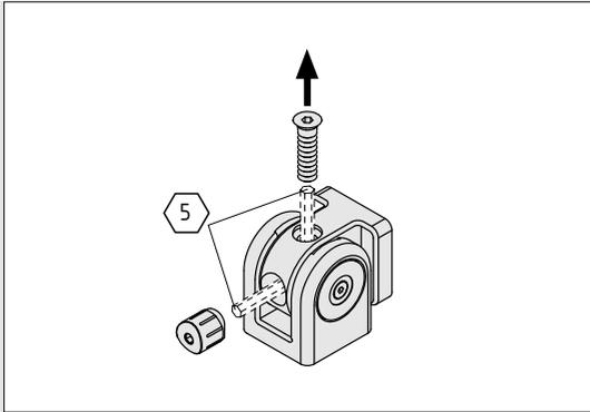
Mit den integrierten Befestigungsschrauben M8x16 kann das Schwenklager an beliebigen Komponenten verschraubt werden. Dies erfolgt mit einem Sechskantschraubendreher SW5 durch die Durchgangsbohrungen des Lagerblocks. Dafür muss nur die Mitnehmerschraube aus dem Lagerblock herausgedreht werden. Eine Demontage des Schwenklagers ist nicht notwendig.
