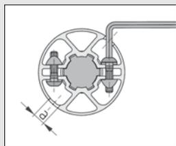
Das Anziehen der Spannschrauben erfolgt durch die vorher eingebrachten Montagebohrungen.
