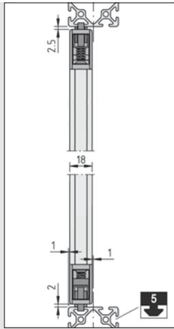
Die Schiebetüren können auch direkt in den Nuten eines Profils der Baureihe 5 geführt werden. So entsteht eine besonders kompakte Rahmenkonstruktion.
