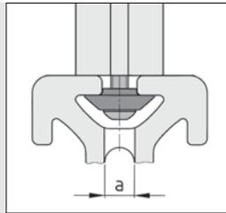
Zusätzlich ermöglichen die Nutscheiben eine Standard-Verbindung (ohne Verdreh-sicherung) von Profilen unterschiedlicher Baureihen.
