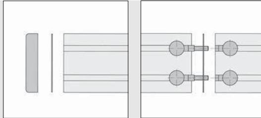
Dichtungen PE müssen zwischen allen Verbindungsstellen eingesetzt werden.
