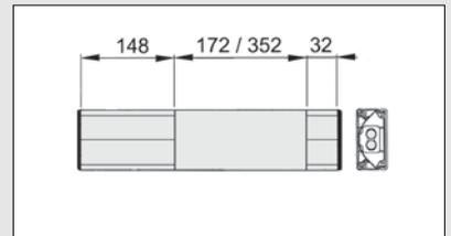
Die Gehäuserückseite ist für die Befestigung mit Halbrundscreiben M5x14 vorbereitet. Voll kompatibel zu den Kanalprofilen.
