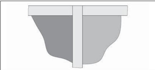
Die Nutzung eines Klemmprofils als Ständer ermöglicht den Bau von Schutzwänden ohne Spalte.
