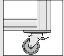
Die Transport- und Fußplatten sind im Zink-Druckgussverfahren hergestellt, allseitig pulverbeschichtet und lassen sich stirnseitig in den Kernbohrungen oder seitlich an der Nut der Profile verschrauben. Gewinde mit verschiedenen Durchmessern ermöglichen die Aufnahme von Ringschrauben, Stellfüßen, Rollen und anderen Elementen.
