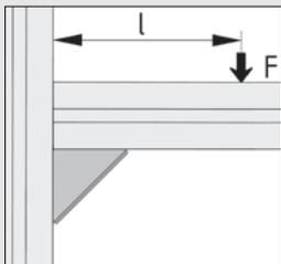
Bei der Anwendung als Verstärkungselement von Verbindungsstellen größerer Profile bzw. Kanäle können mehrere Winkel parallel verwendet werden.
