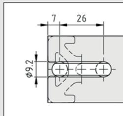
Öffnung der geschlossenen Profilnut 8 zum Einsetzen der Nutensteine von zwei Automatik-Verbindungssätzen 8 N.
