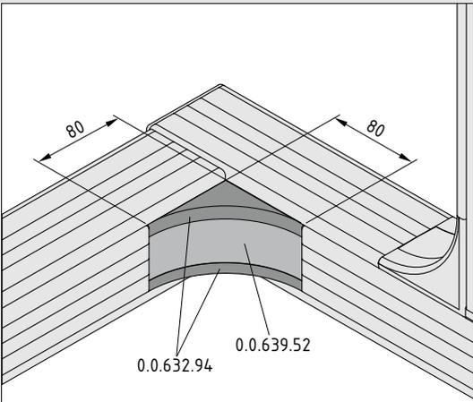
Kanal-Innenecke, Wand an modularen Kanälen, Wandhöhe 80 mm:
