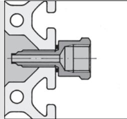
Je nach Anwendungsart ist eine Bearbeitung des Profils notwendig. Bei der Verwendung eines Pneumatik-Anschlusses außerhalb von Kernbohrungen muss ein Standarddichtring eingesetzt werden.
