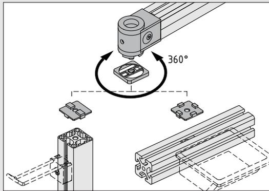
Der Anschluss kann an eine horizontal oder vertikal verlaufende Profil-Nut erfolgen. Die stirnseitige Anbindung an die Profile ist ebenfalls möglich. Alle Gelenke erlauben eine Rotation um 360° und sind im Reibmoment einstellbar.
