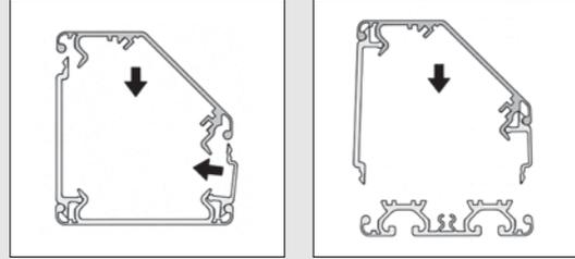
Das Trägerprofil 80-45° ist als Boden- oder Deckelement, das Trägerprofil 160-20° ist ausschließlich als Deckelprofil einsetzbar.
