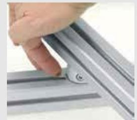
**Demontage:** Nach dem Lösen der Spannschraube wird das Riegelblech aus der Profilvernut gehoben und zurückgeschwenkt. Der KLICK-Verbindungssatz muss nicht zerlegt werden und ist sofort wieder für den nächsten Einsatz bereit.
