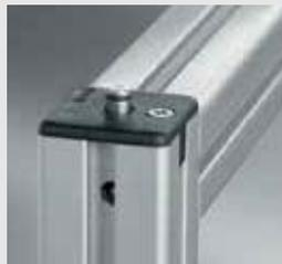
Die Riegel der Stangenschlösser fahren aus der Kernbohrung des Türprofils aus und greifen in die Nut 8 des gegenüberliegenden Zargenprofils ein.
