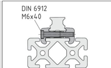
Die Kugelumlaufführung-Schiene PS 4-25 verwendet Befestigungsprofile zur Klemmung. Zur Montage einer Führungsschiene werden je ein Schienenlagerprofil, ein Schienenspannprofil und die entsprechende Anzahl Zylinderschrauben DIN 6912-M6x40 benötigt. Die Schrauben verbinden die beiden Komponenten der Kugelumlaufführung, während die Befestigungsprofile nicht bearbeitet werden müssen.
