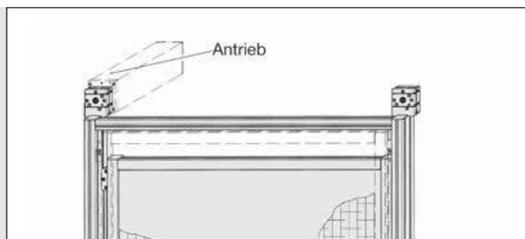
Die Verwendung der Zahnriemenumlenkungen ist Grundlage für einen möglichen Einsatz von Antriebseinheiten. Das Öffnen und Schließen der Hubtüren kann dadurch automatisiert werden. Sie können dann in Fertigungssysteme oder Transportabläufe integriert werden.
