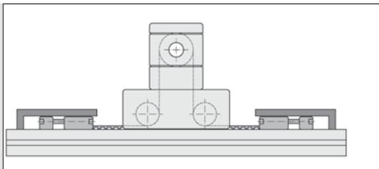
Schematischer Aufbau eines Linearantriebes mit feststehendem Zahnriemen. Die Zahnriemenspanner werden jeweils mit einem Niederhalter fixiert.
