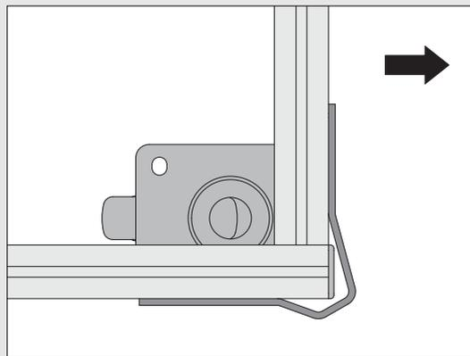
Montagebeispiele für Leit-Eckschutz 8 St 160x160x80 an Grundkonstruktion mit Profilen der Baureihe 8:
