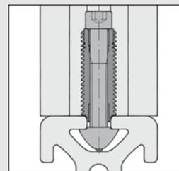
Beim Automatik-Verbindungsatz 6, 8, 10 und 12 kann eine Verdrehsicherung realisiert werden, indem der Verbinder, nachdem das Profil vormontiert wurde, soweit herausgedreht wird, dass das Ende des Verbinders in die andere Profilnut hineinragt.
