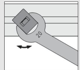
Hierfür wird die Verwendung eines Gabelschlüssels SW20 empfohlen.
