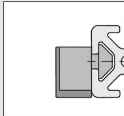
Variabilität der Anschlagfläche durch zwei unterschiedliche Einbaulagen sowie umsteckbaren Höhenausgleich.
