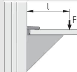
Konsolen X 6-8 sind zum Spannen von Flächenelementen der Dicke 4 bis 10 mm geeignet.
