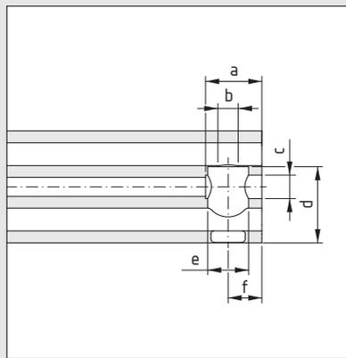
Erforderliche Bearbeitung des abgehenden Profils zum Einsatz des Zentral-Verbindungsatzes.
