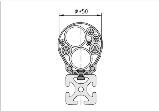
Das geöffnete Klettband kann seitlich aus den Universal-Halter geschoben werden. So entfällt das Durchfädeln von Kabeln.
