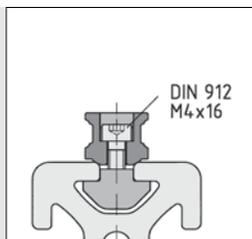
Empfohlene Befestigungsmöglichkeit mittels Nutenprofil 8 Al M4-60 und Zylinderschrauben DIN 912-M4x16 am Profil 8.
