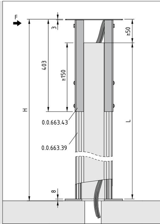
Maximales Drehmoment für Bodenbefestigung Installations säulenprofil, beispielhaft für gerissenen Beton C20/C25 in Verbindung mit dem Bodenbefestigungssatz M10x135 (0.0.485.82):
