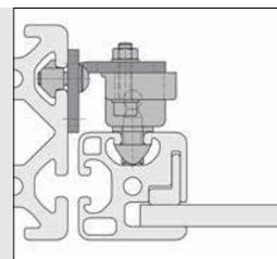
Die Langlochbefestigung des Kugelschnäppergehäuses ermöglicht den Versatz von Schiebetür und Ständerprofil. Empfohlene Befestigung mittels Zylinderschraube DIN 912-M5 und Scheibe DIN 125-5,3 am Profil.
