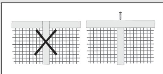
Die Anbindung der Klemmprofile mit zwei Flächenelementen kann nur an der Profilstirnseite erfolgen. Die Profilleisten der durchgehenden Klemmprofile müssen entsprechend unterbrochen werden.
