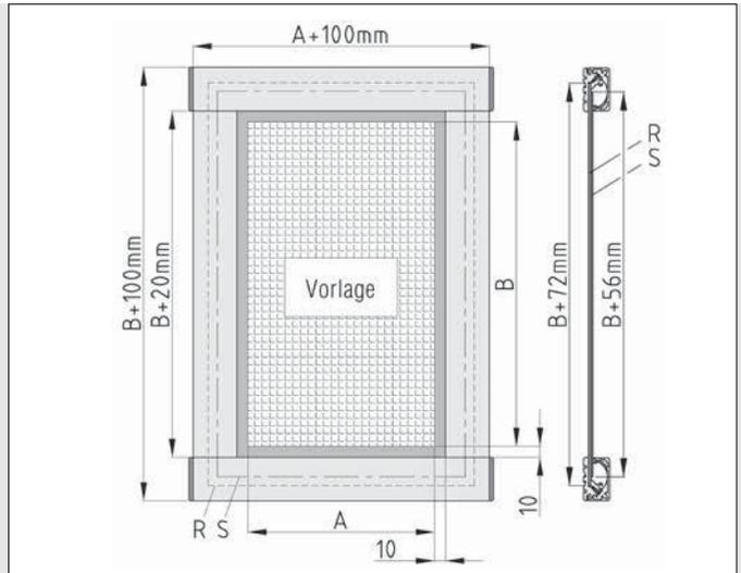
Ermittlung der Anzahl und Längen der Einzelkomponenten für den Bau von Vorlagehaltern als Rahmen.
