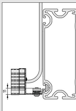
Für eine optimale Positionierung der Stromversorgung kann die robuste Steckdosenleiste in Industriequalität an den Profilmuten von Maschinenrahmen oder Aufbauten montiert werden. Der Netzanschluss erfolgt über einen festen Anschluss, der zum Lieferumfang gehört.
