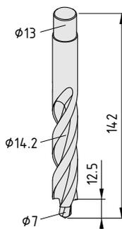
**Stufenbohrer, Gehrungs-Verbindung 8**
