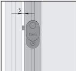
Das Spaltmaß zwischen Türprofil und seitlicher Zarge darf maximal 5 mm betragen.
