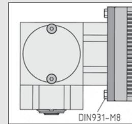
Bei beengten Platzverhältnissen können Sechskantschrauben DIN 931-M8 verwendet werden.
