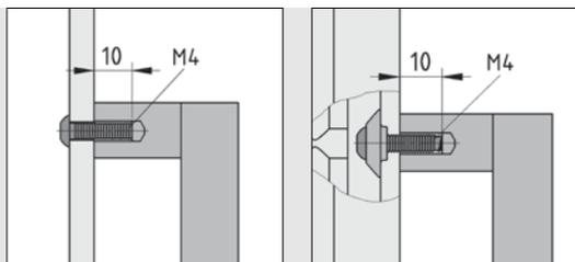
Beim Verschrauben auf Profalnuten wird die Verwendung der entsprechenden Nutscheiben empfohlen.
