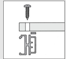
Einseitig selbstklebendes Dichtband zur Abdichtung von Rahmenelementen. Zusätzlich als dämpfendes Element auf Anlageflächen besonders in Kombination mit der Winkelschraubleiste 8 Al geeignet.
