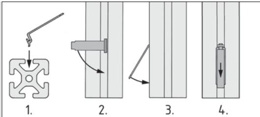
Für den Automatik-Verbindungssatz 8 ist optional eine Abdeckblende erhältlich. Sie wird abschließend montiert.
