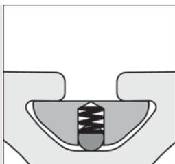
Nutensteine St, schwer werden von der Stirnseite des Profils in die Nut eingeschoben und sind dort über ein federndes Druckstück vorfixiert.
