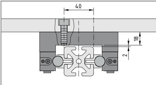
Universelle Anschlussbohrungen in der Schlittenplatte: Gewindebohrungen M8 zur Befestigung von Profilen oder beliebigen Aufbauten.
