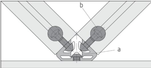
Die Winkelemente werden mit Halbrundschaubren, Universalverbinder oder Automatikverbindern und einem speziellen Nutenstein verschraubt (siehe Tabelle).
