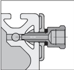
Versorgung des Profilhohlraums über eine Zentralbohrung im Nutgrund in Verbindung mit Pneumatik-Anschluss-Satz. Die Abdichtung erfolgt an dem Kegelsitz des Pneumatik-Anschlusses.
