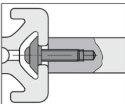
Befestigungsmöglichkeit von hinten (verdeckt) mit Schrauben M5. Die Adaptierung an Profilen verschiedener Baureihen ist durch die Verwendung von Nutscheiben möglich.
