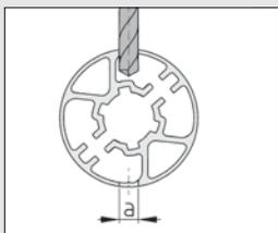
Die Montagebohrungen für die Spannschrauben werden an den Anrissrillen senkrecht zur Profilmittelachse eingebracht.
