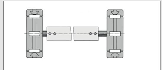
Umlenkung des Zahnriemens um 180°, wobei dieser innerhalb oder außerhalb des Profils zurückgeführt werden kann. Die Zahnriemenscheibe ist mit Vielkeilverzahnung zum Anbau von Antriebseinheiten bzw. Vielkeil- und Adapterwellen oder mit Bohrung zur Bearbeitung für andere Welle-Nabe-Verbindungen vorbereitet.
