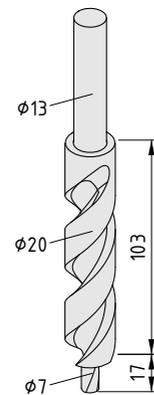
**Stufenbohrer, Universal-Verbindung 8, D13**
