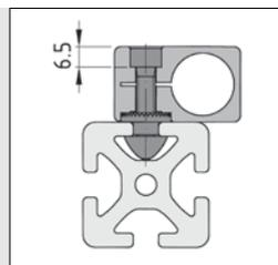
Die Endschalterhalter D6.5, D8 und D12 können mit der Verdrehsicherung parallel oder rechtwinklig zur Profillinie 5 oder 8 angebunden werden.
