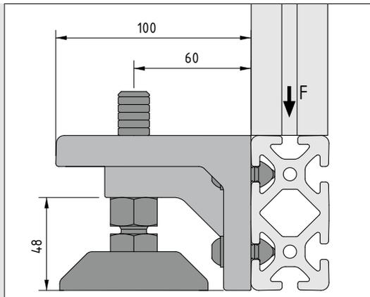
Der Einsatz des Stellfußsockels 8 D80 ermöglicht die Verwendung höhenverstellbarer Stellfüße mit Gewindespindel M16 (vorzugsweise Stellfüße D80, M16) seitlich an einer Rahmenkonstruktion. Maschinen oder Anlagen können so mit geringem Abstand zum Boden, aber dennoch höhenverstellbar aufgestellt werden.
