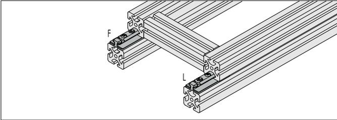
Gleitführungen mit mehreren Gleitschlitten müssen als Kombination aus Festlager (F) und Loslager (L) ausgeführt werden. Hierdurch werden Formtoleranzen ausgeglichen und eine leichte Beweglichkeit sichergestellt. Der mittlere Gleitreibungskoeffizient einer Gleitschlittenführung beträgt  $\mu = 0,22$ .
