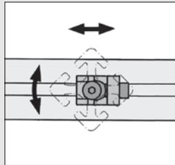
Der Direkt-Verbindungssatz 8 90° ist auch geeignet für die verschiebbare Anbindung von Profilen mit teilweise geschlossenen Nuten, bei denen die Verwendung von Universal- oder Automatikverbindungen nicht erwünscht ist.
