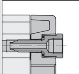
Versorgung einer Zentralbohrung über stirnseitigen Einbau einer Pneumatik-Anschlussplatte mit Pneumatik-Anschluss.
