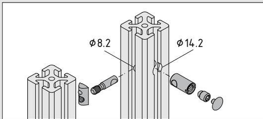
**Profilbearbeitung:** Zur Aufnahme des Verbinder-Lagers erhält eines der zu verbindenden Profile eine seitliche Bohrung  $\varnothing 14,2$  mm (Verwendung des Stufenbohrers; Art.-Nr. 0.0.492.60) sowie eine dazu senkrechte Verbindungsbohrung  $\varnothing 8,2$  mm.
