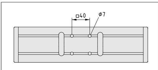
Die Profilmuten 8 des Gehäuseprofils können zur Befestigung der Zahnriemenumlenkung wie auch zum Verschrauben mit der Schlittenkonstruktion genutzt werden.
