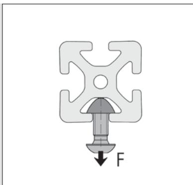
Zulässige Zugkraft  $F$  auf die Nutflanken. Diese Nennlast beinhaltet bereits Sicherheitsfaktoren ( $S > 2$ ) gegen plastische Deformation oder Bruch.
