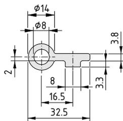
**Scharnierlappenprofil V 8 z 18 leicht**
