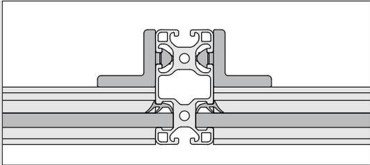
Die Verbindung der Profile 8 F14 untereinander kann ohne Profilbearbeitung mit Winkeln V 8 40 Zn (Art.-Nr. 0.0.486.28) erfolgen. Diese Winkel weisen an ihrer Rückseite eine Verdreh-sicherung auf, die sie lagerichtig in der Profilmutter positioniert.
