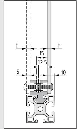
Zum Einsetzen des Multiblocks X PA in Profile mit geschlossenen Nuten wird empfohlen, die Nutabdeckung an der gewünschten Position mit einer Senkbohrung zu entfernen. Hierzu ist der Stufenbohrer Universal-Verbindung 6 (Art.-Nr. 0.0.431.19) besonders geeignet. Die erforderliche Senkungstiefe beträgt nur 2 mm!
