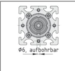
Anschlussmaße der Lagerblöcke der Los (L)- und Fest-lagerseite (F). Je nach Wahl der Antriebsart müssen die Lagerblöcke und die Antriebsaufnahmen bearbeitet werden.
