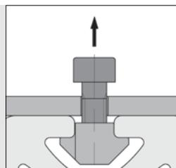
Die Nutensteine Zn können bei Bedarf mit der Schraube am zu befestigenden Bauteil vormontiert und an einer beliebigen Stelle in die Profilnut eingesetzt werden.
