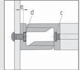
Die Gelenke mit Klemmhebel können festgestellt und wieder gelöst werden. Besonders geeignet sind sie für verstellbare Halterungen, schwenkbare Ausleger für Greifschalen oder ähnliche Einrichtungen.
