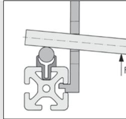
Einsatz eines Hebels aus Rundstahl beim Einpressen der Führungswelle
