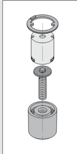
Die Spindel wird in ein Gewinde M8 in der Kernbohrung des Profils verschraubt. Die Höhenverstellung erfolgt ohne Werkzeug alleine durch manuelles Drehen des Fußunterteils.
