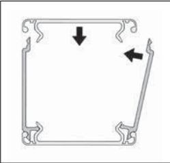
Einfacher Aufbau der modularen Kanäle durch Einschwenken der Wandprofile in die Trägerprofile.
