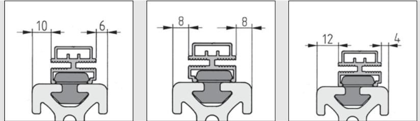
Zur Anpassung an die Wandstärke des Flächenelementes sind verschiedene Drehlagen der Winkelschraubleiste 8 Al und des asymmetrischen Klipp 8 PA möglich.
