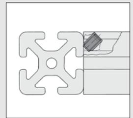
Der Potentialausgleich 5 und 6 wird in die Profilvernuth eingeschwenkt und anschließend an die Verbindungsstelle geschoben.
