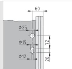
Das Flächenelement muss gegebenenfalls mit Bohrungen für Türdrücker und Standard-Schließzylinder versehen werden. Das Schlossgehäuse enthält dafür vorgeformte Öffnungen. Der Abstand zur Türkante bestimmt die Lage der Durchgangsbohrungen im Flächenelement für Türdrücker und Profilzylinder.
