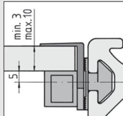
Durch die unterschiedliche Lage der Anschlagflächen lassen sich variable Einbaumaße realisieren.
