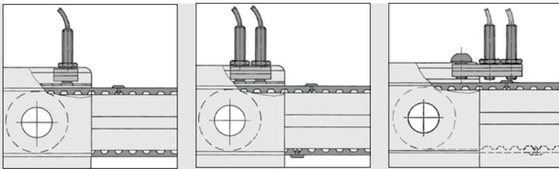
Befestigungsmöglichkeiten der Endschalter 8 in Verbindung mit Endschalterbefestigung. Je nach Anwendung muss die Endschalterbefestigung entsprechend gekürzt werden.
