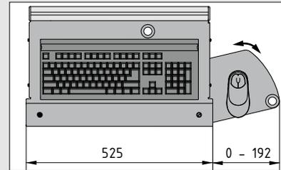
Der Tastaturhalter trägt die Tastatur des Rechners und die Maus. Mit seiner Schraubbefestigung kann er an Schwenkarmen oder im Greifraum fest angebracht werden. Durch den Befestigungssatz ist auch eine ausziehbare Variante unter der Arbeitsfläche möglich.
