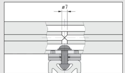
Zur Befestigung an Flächenelementen muss die Verdrehsicherung entfernt werden.
