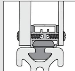
Winkelschraubleiste in Verbindung mit Dichtband 6x3 sk bei doppelwandigem Aufbau.
