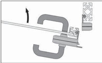
Schwenktür mit innenliegendem Schloss, Anschlag über Schlossgehäusefalg am Schlossgehäuse.
