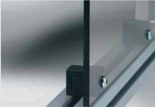
Der Multiblock PA wird an beliebiger Position in die Profilvernut eingeschwenkt. Leichte Verkleidungsbleche, Flächenelemente aus Acrylglas, Vollkunststoff oder Verbundmaterial müssen an der entsprechenden Stelle mit einer Bohrung versehen und mit dem Multiblock verschraubt werden.
