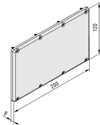
**Elektronikgehäuse-Deckel 8 200x120, glatt**
