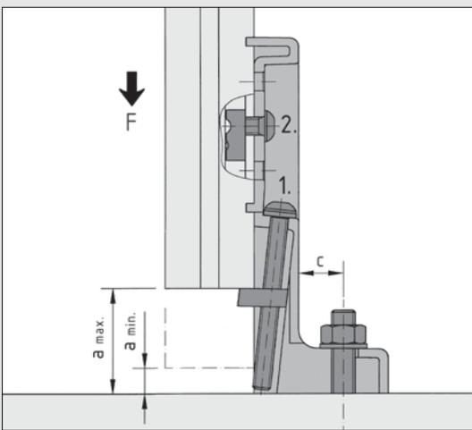
Die Verstellung des Winkelstellfußes ermöglicht einen einfachen Ausgleich von Bodenunebenheiten durch Höhenverstellung. Dies erfolgt durch Drehen der Einstellschraube (1.). Die gewählte Höhe wird dann durch Anzug der seitlichen Befestigungsschraube fixiert (2.).
