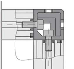
Verbindung der Klemmprofile E mit den Klemmprofil-Verbindern E.
