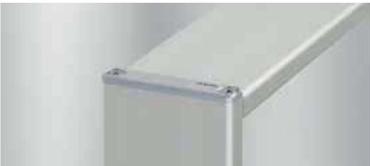
Die Abdeckkappe 8 80x16 Zn wird mit den beiliegenden Schrauben in den Profilen 8 80x16 kraftschlüssig verbunden und widersteht so dauerhaft Stößen und Vibrationen. In den beiden Schraubkanälen der flachen Profile muss ein Gewinde gebohrt werden.
