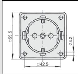
Befestigung des Steckdosen-Gehäuses mit vier Blechschrauben DIN 7981 St-4,2x9,5 (Art.-Nr. 0.0.196.13).
