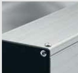
Die Verrasterung von Wand- und Deckelprofilen kann bei Bedarf mittels Blechschraube St 4,2x9,5 verriegelt werden. Die Trägerprofile müssen dazu mit einer Bohrung  $\varnothing$  3,5 mm in der Anrissrille versehen werden. Durch die Verschraubung entsteht eine elektrisch leitfähige Verbindung der Kanalelemente.
