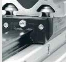
Die Befestigung von Profilen 8 auf den Kugelumlaufführung-Wagen erfolgt mit Halbrundschräuben ISO 7380 und Nutscheiben 8.
