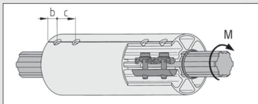
Der Klemmsatz enthält alle Bauteile zur Befestigung von Vielkeilwellenabschnitten an beiden Enden eines Synchronwellenprofils.
