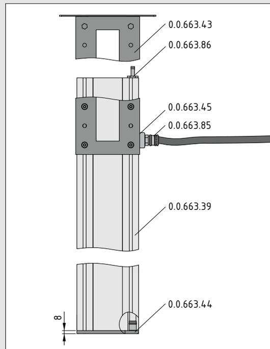
Anwendungsbeispiel für den freistehenden Einsatz der Installationsprofile mit verschraubten Abdeckkappen und verschiedenen Pneumatik-Komponenten wie etwa Dichtstopfen.
