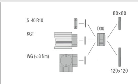
Die Kupplung D30 ist durch die Anschlussmaße und den zulässigen Drehmomentenbereich ( $M_D < 8 \text{ Nm}$ ) besonders für die Verwendung mit den Kugelgewindetriebe (Spindeleinheiten KGT; Zentrierung D50-D50), der Zahnriemenumlenkung 5 40 R10 mit Vielkeil VK14 (Zentrierung D50-D22) und optional den Winkelgetrieben WG (Zentrierung D50-D50) geeignet.
