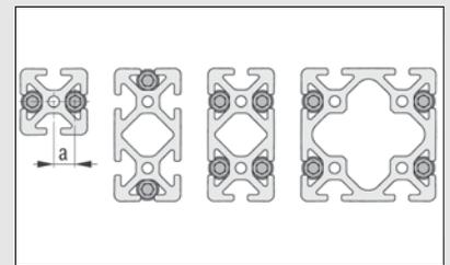
Der Verbinder wird stirnseitig in eine Profilnut eingeschraubt, wobei er sich das Gewinde selbst schneidet. Hierbei wird die Verwendung von Schmiermittel empfohlen.
