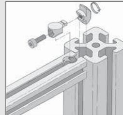
Universal-Verbindungssätze sollten grundsätzlich paarweise verwendet werden. Für bestimmte Anwendungen kann die Verdrehsicherung des Universalverbinders an einer Sollbruchstelle abgebrochen werden.
