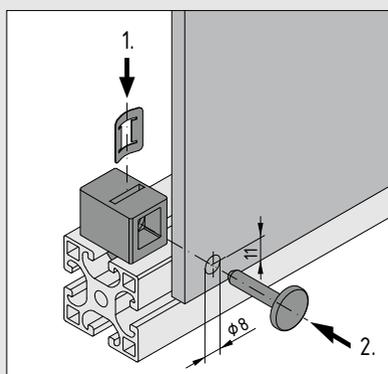
Rastmultiblocke können für Flächenelemente beliebiger Dicke (bis 8 mm) verwendet werden. Die zwei unterschiedlichen Einbaulagen (Abstand zur Profilkante 4 oder 8 mm) ermöglichen die Anpassung an die Flächendicke. Die Rastfeder ist entsprechend der Belastungsrichtung in den Rastmultiblock einzusetzen: die Wölbung der Feder muss der Einsteckrichtung des Zapfens entgegen gerichtet sein. Das Eindrücken des Zapfens spannt zugleich die Feder.
