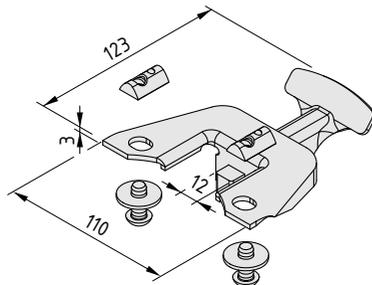
**Richtungsfeststeller für Lenkrolle D160/D200 140x110**
