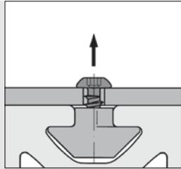
Beim Anziehen der Schraube wird der Nutenstein automatisch in der Nut verriegelt.
