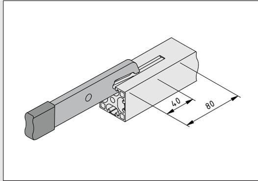
Der Nutöffner 8N wird, ausgehend von der Profilstirnseite oder einer ausreichend großen Startöffnung, verwendet, um die Nutabdeckung auf beliebiger Länge zu entfernen. Wird die Öffnung nicht bis ans Profilende durchgeführt, muss das Ende der Öffnung mit einer Bohrung  $\varnothing 9,2$  mm festgelegt werden.
