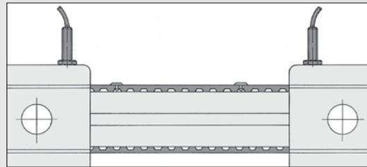
Mögliche Anordnung von Endschaltern 8 und Endschalternocken 8:
