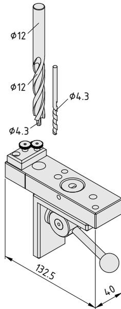
**Bohreinheit, Bohr-Adaptersatz 5**
