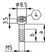
**Zylinderschraube DIN 6912 M5x8**
