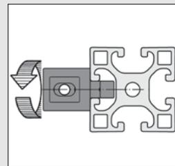
Der Rastmultiblock 8 wird in die Profilnut eingesetzt und mit einer 90°-Rechtsdrehung verriegelt.
