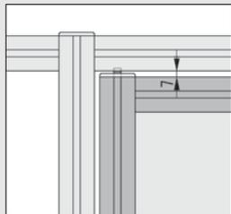
Das Spaltmaß zwischen Türprofil und oberer Zarge darf maximal 7 mm betragen.
