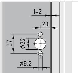
Bearbeitung des Flächenelements zum Einsatz des Verschlussystems mit Rosette/Griff.
