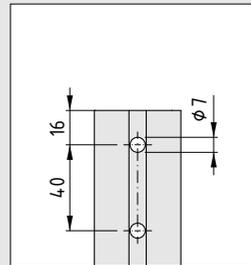
Position der Durchgangsbohrungen für den Schraubendreher.
