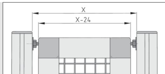
Das Spaltmaß zwischen Rahmen und Ständerprofilen beträgt 12 mm. Durch die Klemmprofil-Aufhängung E können dabei Maßtoleranzen von  $\pm 3$  mm ausgeglichen werden.
