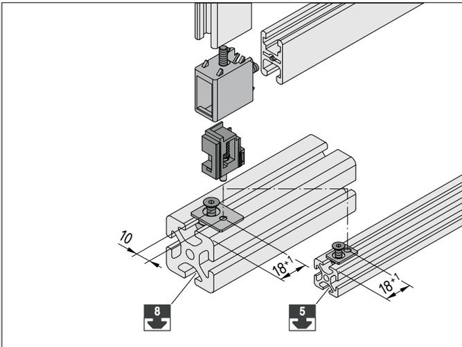
Die Scharniereinsätze werden ebenfalls in die Eckverbinder eingebaut, nachdem der Klemmprofil-Rahmen geschlossen wurde.
