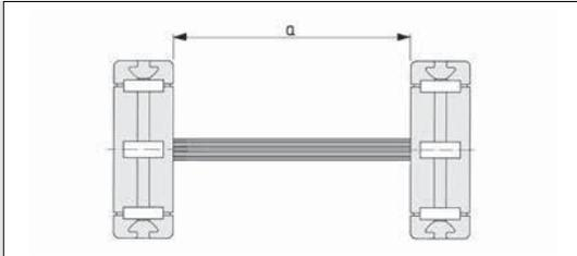
In Verbindung mit den Zahnriemenumlenkungen zur Erzeugung synchroner Bewegungsabläufe bis zu einem Abstand  $a$  geeignet.
