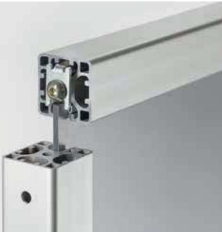
Um den Versatz von Profilen zu ermöglichen, besitzt der Standard-Verbindungssatz 8, einseitig eine modifizierte Zentrierhilfe. So können Sie rechteckige Profilverbindungen konstruieren, die inklusive Abdeckkappen bündig abschließen (a). Weil sich außerdem
