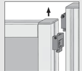
Es ist auch eine Kombination von Profilen 6 und 8 durch Wenden der Verdrehsicherung in den Aufhängungen möglich.
