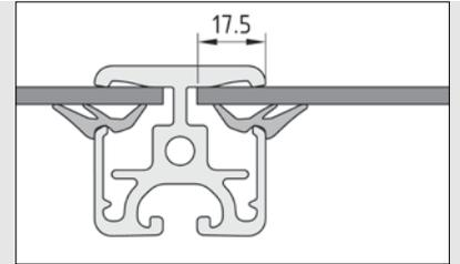
Eine klapperfreie Befestigung von eigenstabilen Flächenelemente kann durch Dichtprofile 8 erfolgen.
