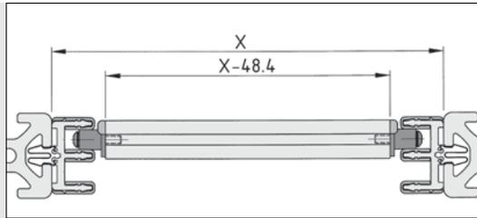
Die Rollladen-Endleiste bildet den Abschluss des Rolladens. An ihr können Griffe oder ein Griffsystem befestigt werden. Das Rollladen-Verschlussystem 8 wird in eine Bohrung in der Rollladen-Endleiste eingesetzt. Eine detaillierte Montageanweisung liegt dem Rollladen-Kurvenführungssatz 45° bei.
