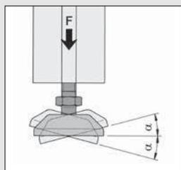
Die höhenverstellbaren Stellfüße eignen sich für Einrichtungen aller Art. Die Stellfüße können je nach Anwendungsfall in den Kernbohrungen der Profile oder in Kombination mit den Transport- und Fußplatten montiert werden. Sie sind erweiterbar mit den entsprechenden Einsätzen und Klemmlaschen.
