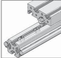
Anordnung der Kunststoff-Feder in der Nut des Tragprofils. Der Gewindestift M8x44 wird in der gegenüberliegenden Nut des Führungsschlittens befestigt.
