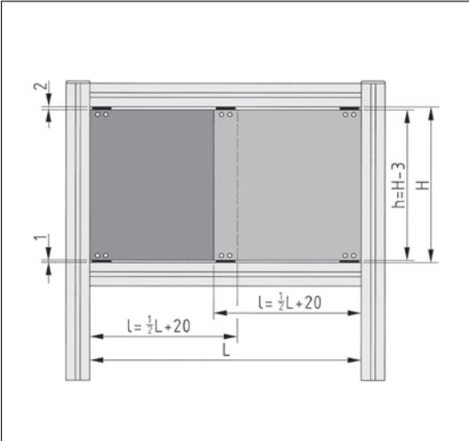
Es können wahlweise eine oder zwei Schiebetüren in einer Profilvernut 8 geführt werden. Die Gleitstücke bilden in der Endlage einen Anschlag bzw. einen Mitnehmer der zweiten Tür.
