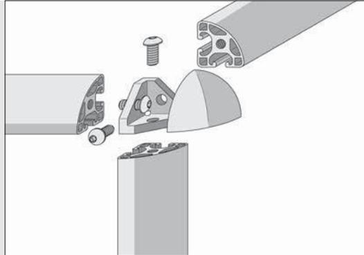
Verbindungssätze ermöglichen den Aufbau einer Raumecke mit 3 Profilen bzw. eines Eckwinkels mit 2 Profilen unter Weiterführung der Profilgeometrie.
