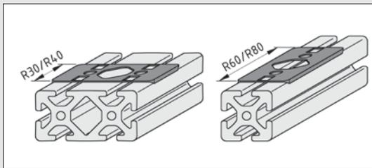
Die Bezeichnung R30, R40, R60 bzw. R80 weist auf die Länge der dem Profilradius zugewandten Seite der Dichtung hin.
