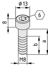
**Zylinderschraube DIN 912 M8x60**
