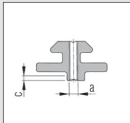
Erforderliche Bearbeitung und Befestigungselemente zum Festsetzen der Gleitführungsleiste auf der Festlagerseite.
