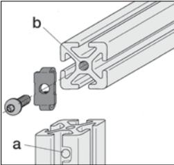
In die Kernbohrung der Profile wird direkt das erforderliche Gewinde gebohrt.
