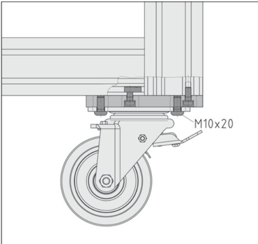
Die Rollen-Adapterplatten für die Rollenserie D125 schwer sind mit den erforderlichen Durchgangsbohrungen in den Rastermaßen der Profilbaureihen 8 bzw. 12 versehen. Außerdem enthalten sie vier Befestigungsgewinde M10 für Rückenplatten von Rollen in den nach DIN 8458 – Größe 3 genormten Bohrungsmaßen.
