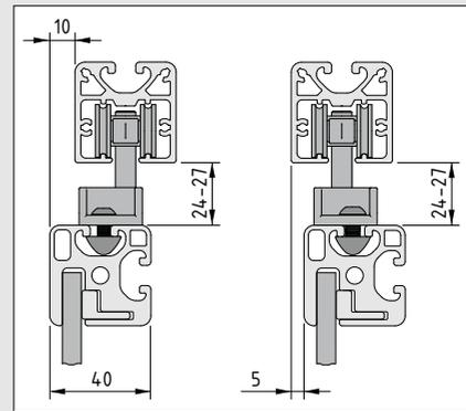
Das Laufbahnprofil 8 40x40 mit der universellen Profilnut 8 ist einfach befestigt und führt den Laufwagen.
