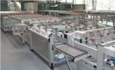
Der MB Systembaukasten von item ist die erprobte Grundlage für Maschinen und Anlagen jeder Größenordnung. Die Profile 8 sind dabei die weltweit am häufigsten eingesetzte Baureihe. Durch ihre Formgebung sind die Aluminiumprofile leicht und robust, flexibel in der Anwendung und viele Jahre lang nutzbar. Durch die große Auswahl an Modulen lassen sich mit den Profilen 8 alle Konstruktionsaufgaben lösen.
