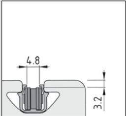
Die Kettenumlenkungen werden stirnseitig in den Kernbohrungen der Rahmenprofile verschraubt. Das Kettenführungsprofil ist 50 mm länger abzumessen als das Rahmenprofil, da es auf jeder Seite 25 mm in die Umlenkung hineinragen muss.
