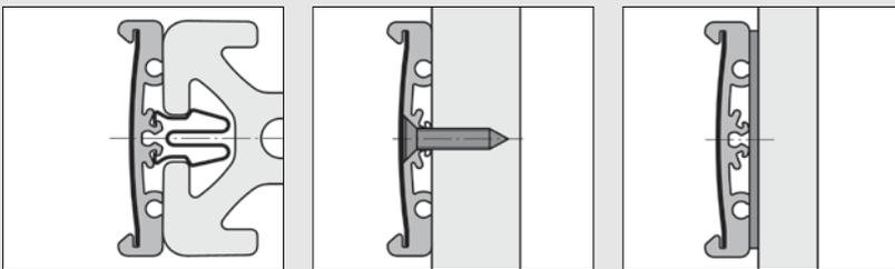
Der Beschriftungshalter 8 kann an verschiedenen Unterkonstruktionen befestigt werden:
