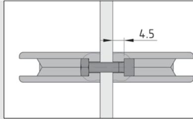
Handgriffe PA zur universellen Anwendung mit Befestigungsmöglichkeit von vorn oder hinten (verdeckt), besonders geeignet für Schiebe- und Schwenktüren.
