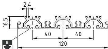
**Trägerprofil 120 mit Nuten 8**
