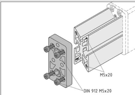
Zur vielfältigen Anbindung des Innenprofils an eine Anschlusskonstruktion ist die zusätzlich erhältliche Teleskop-Anschlussplatte 8 80x40 geeignet. Sie dient zur Verschraubung mit Komponenten der Baureihe 8 oder beliebigen Bauteilen. Dazu sind bereits entsprechende Durchgangsbohrungen und Senkungen in der Anschlussplatte vorgesehen.
