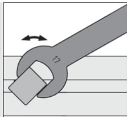
Der Universal-Halter 8 wird ohne zusätzliche Befestigungselemente direkt in die Profillinute eingesetzt und dort mit einer 90°-Drehung verriegelt. Hierfür wird die Verwendung eines Gabelschlüssels SW 17 empfohlen.
