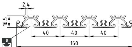
**Trägerprofil 160 mit Nuten 8**
