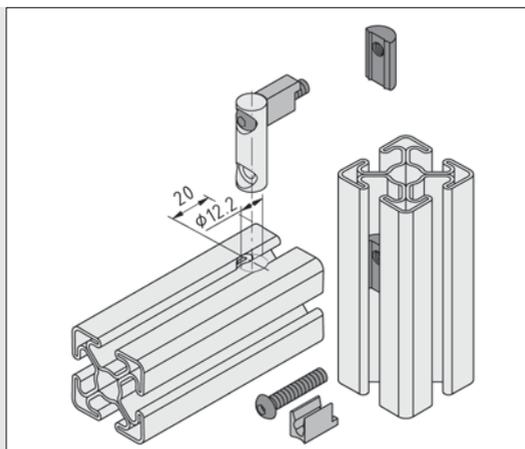
Die Vorspannkraft des Universal-Verbindungssatzes St 8 wird durch zwei Schrauben aufgebracht, die von der Profilverbindung her angezogen werden. Sie werden in Nutensteine Profil St 8 M6 verschraubt, die in der gegenüberliegenden Profilverbindung eingesetzt werden.
