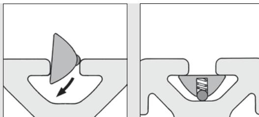
Einschwenken der Nutensteine St in die Profilkut und Fixierung über Druckstücke.
