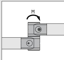
Die maximale Momentenbelastung eines Standard- und Anschlussgelenks beträgt 45 Nm, das Doppelgelenk 40 darf mit 60 Nm und das Doppelgelenk 80 mit 200 Nm belastet werden.
