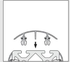
Für eine komplett geschlossene Oberfläche müssen sowohl die Abdeckkappe des eckigen Grundprofils als auch Abdeckkappen R oder F für die Segmente des jeweiligen Abdeckprofils verwendet werden.
