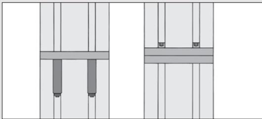
Möglichkeiten von Stoßverbindungen mit Adapterplatten und Automatikverbindern.
