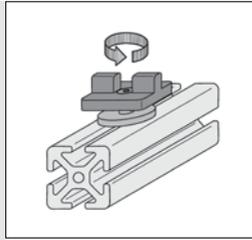
Durch die freie Rotation des Nutgleiters um die Nutgleiternabe werden auch mögliche Fluchtungsfehler ausgeglichen.
