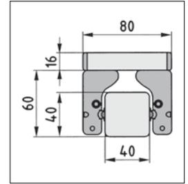
Grundkonstruktion aus Profilen der Baureihe 8 mit Rollenführung 8 auf Welle D6.
