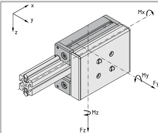
Vereinfachtes Verfahren zur Bestimmung der maximal zulässigen Belastung der Schlittensätze LRF 8:
