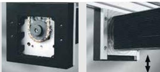
Durch Verschieben des Motors mit der Adapterplatte der Ketten-Gegenumlenkung kann die Kette gespannt werden, wenn die Einstellung nicht an den Kettenumlenkungen vorgenommen werden kann.
