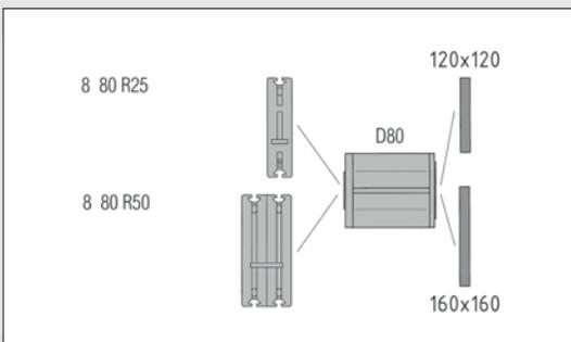
Für die Übertragung der großen Drehmomente ( $M_D < 100 \text{ Nm}$ ) der Zahnriemenumlenkungen 8 80 R25 und 8 80 R50 II mit Vielkeil VK32 wird die Kupplung D80 mit einem entsprechend großen Kupplungsgehäuse eingesetzt. Das Kupplungsgehäuse ist mit einer entsprechenden Zentrierung ( $\varnothing 60 \text{ mm}$ ) für die Zahnriemenumlenkungen versehen.
