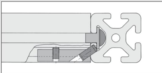
Das Verstiftungselement wird stirnseitig in die Profilvernut eingeschoben und nach Ausführung der Standard-, Universal- oder Automatik-Verbindungen an das Profilende geschoben und dort fixiert. Für den Zylinderstift wird eine Bohrung (Baureihe 8:  $\varnothing$  5,9 mm; Baureihe 12:  $\varnothing$  9,9 mm) in das Profil eingebracht.
