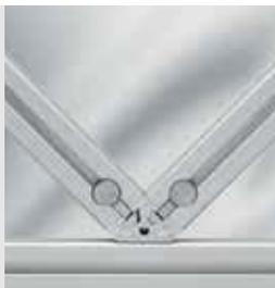
Die Nutensteine St mit zwei Gewinden werden vorzugsweise in Verbindung mit den Winklelementen T2 und Universal- bzw. Automatikverbindern (siehe Kapitel Verbindungstechnik) zur Konstruktion stabiler Fachwerke eingesetzt. Sie können aber auch bei allen anderen Profilverbindungen genutzt werden.
