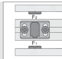
Die Magnetverschlüsse sind vorzugsweise zur Zuhaltung von Schwenk- und Schiebetüren geeignet. Durch 180°-Drehung des Magnetverschlusses erhalten sie eine unterschiedlich große Haltekraft (nicht bei Magnetschnäpper X). Über Langlöcher werden die Magnetverschlüsse an die Stärke des Flächenelementes angepasst. In Verbindung mit Schnäpper-Befestigungswinkeln können sie auch an Türen mit Profilrahmen eingesetzt werden.
