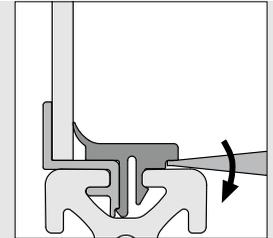
Die Scheibeneinfassleisten bestehen aus zwei Komponenten: einer Aluminiumleiste, die in die Profilmutter eingesetzt wird und die Scheibe aufnimmt. Anschließend wird mit einer zweiten elastischen Kunststoffleiste die Scheibe sowie die Aluminiumleiste in der Nut fixiert. Bei Bedarf kann die Kunststoffleiste wieder gelöst werden, um die Scheibe aus dem Rahmen zu entnehmen.
