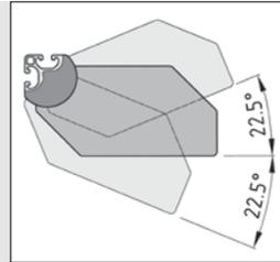
Zur ergonomischen Anpassung an die örtlichen Gegebenheiten lässt sich die Leuchte rastend mit einem Schwenkbereich von  $\pm 22,5^\circ$  um die Nulllage verstellen.
