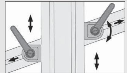
Der Klemmwinkel ermöglicht in Kombination mit einem Gelenkwinkel oder mit einem zweiten Klemmwinkel eine einfache Verbindung zweier sich kreuzender Profile. Das Öffnen der Schraube bzw. des Klemmhebels hebt gleichzeitig die Spannung beider Profalnuten auf und ermöglicht so eine freie Drehlage und die Verschiebung beider Profile längs der Nuten.
