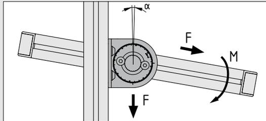
Ein verstellbarer Profilrahmen mit 2 Winkelfeststellungen 8 80x40 ist mit einer Kraft  $F_{\max} = 2.000 \text{ N}$  belastbar. Zulässiges Belastungsmoment dieses Profilrahmens:  $M = 100 \text{ Nm}$
