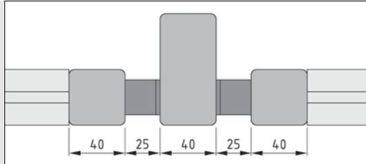
Aufhängung 8 in Verbindung mit Klemmprofil 8 40x40.
