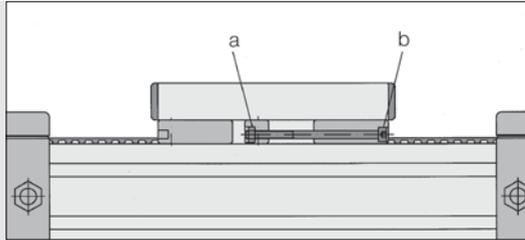
Befestigungsmöglichkeiten und Spannen des Zahnriemens an einem Führungsschlitten mit Spannblöcken und Gegenlager und den dazugehörigen Schrauben.
