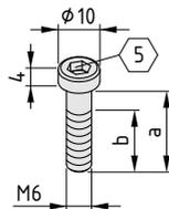
**Zylinderschraube DIN 6912 M6x40**
