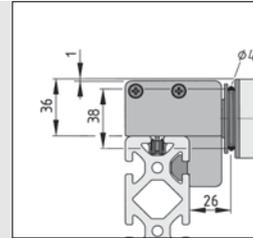
Das Gehäuse der Kettenumlenkung ist zur Befestigung eines Lagerblocks vorbereitet. Diese Transportrolle wird nicht über die Kette angetrieben. Bei Bedarf kann die letzte Transportrolle mit einem Rundriemen  $\varnothing 4$  mm von der letzten angetriebenen Rolle mit angetrieben werden.
