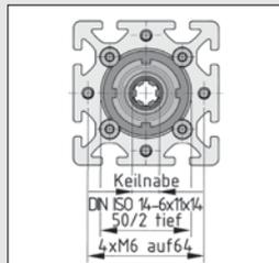
Die Nabe ist aufbohrbar auf max. Ø 17 mm oder Ø 14 mm zum Einbringen einer Passfedernut nach DIN 6885 T1.
