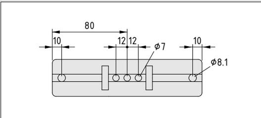
Die Profilvernutzung auf der Rückseite der Zahnriemen-Gegenumlenkung ermöglicht die Befestigung der Zahnriemenumlenkungen und Endschalter M8.
