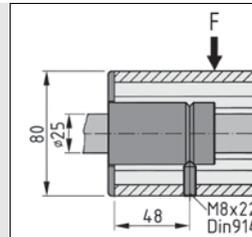
Die Kugelhülseneinheiten werden mittels Gewindestift DIN 914-M8 in den Hohlräumen der Profile 8 festgesetzt.
