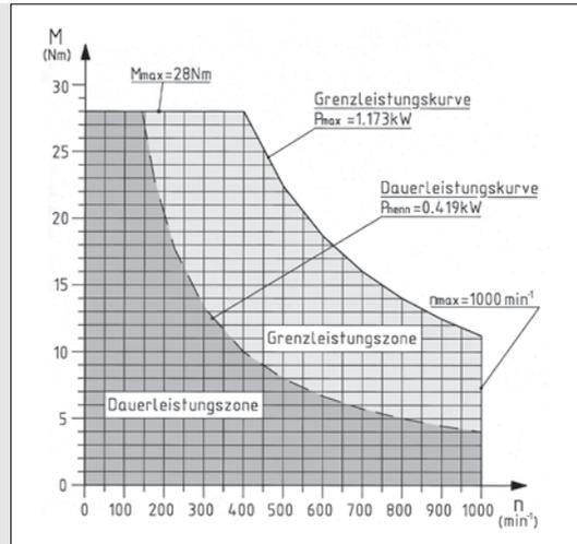
Das Diagramm ermöglicht die Ermittlung der zulässigen Drehmomente  $M$  und Drehzahlen  $n$  der Winkelgetriebe. Bei Belastungen im Bereich der Dauerleistungszone sind Einschalt-dauern von 100% zulässig. Im Bereich der Grenzleistungszone müssen die Einschalt-dauern entsprechend reduziert werden.
