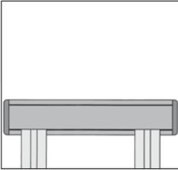
Unterbrechung des Griff-Abdeckprofils bei rechtwinkliger Profilanbindung.
