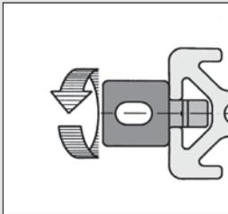
Einschwenken des Multiblocks PA in der Profilvernut. Die Multiblöcke sind in der Nut verschiebbar, um eine Ausrichtung zur Bohrung im Flächenelement durchzuführen.
