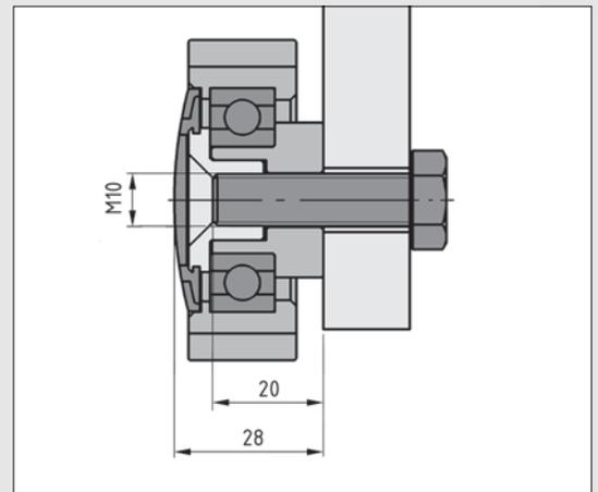
Auch der Einsatz in Form einer Laufkatze für Hängebahnen ist ideal mit Laufbahnprofilen und Rolleneinheiten auszuführen.
